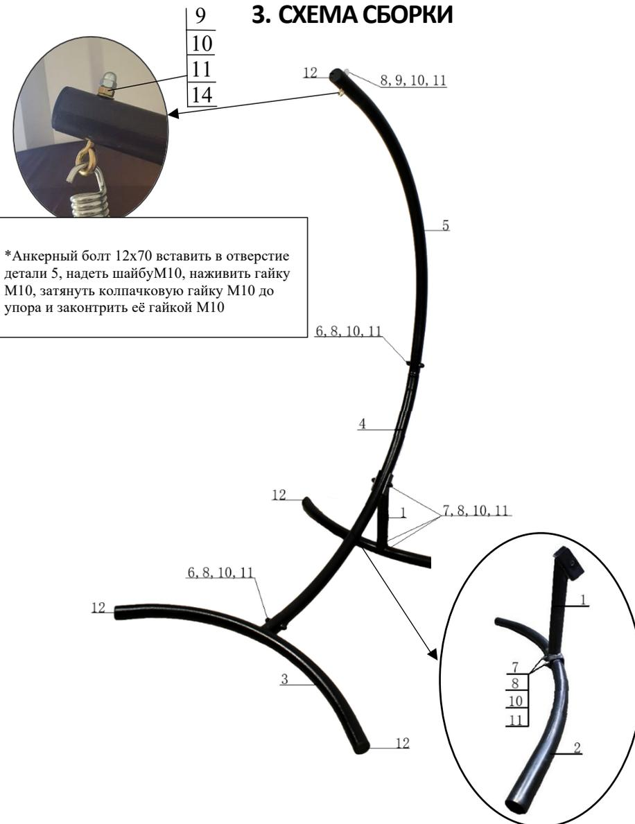
\*Анкерный болт 12х70 вставить в отверстие детали 5, надеть шайбу М10, наживить гайку М10, затянуть колпачковую гайку М10 до упора и законтрить её гайкой М10
