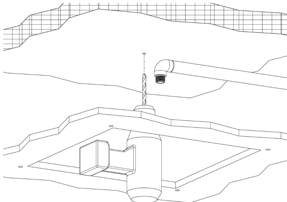
Forare con punta Ø8 il soffitto in funzione della traccia eseguita al punto precedente.
