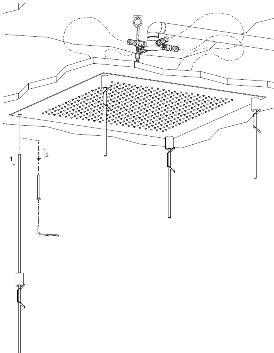
Svitare una barra filettata e fissare il soffione serrando con una delle 4 viti a testa svasata fornite utilizzando una chiave a brugola da 3 mm ed interponendo le rondelle.
