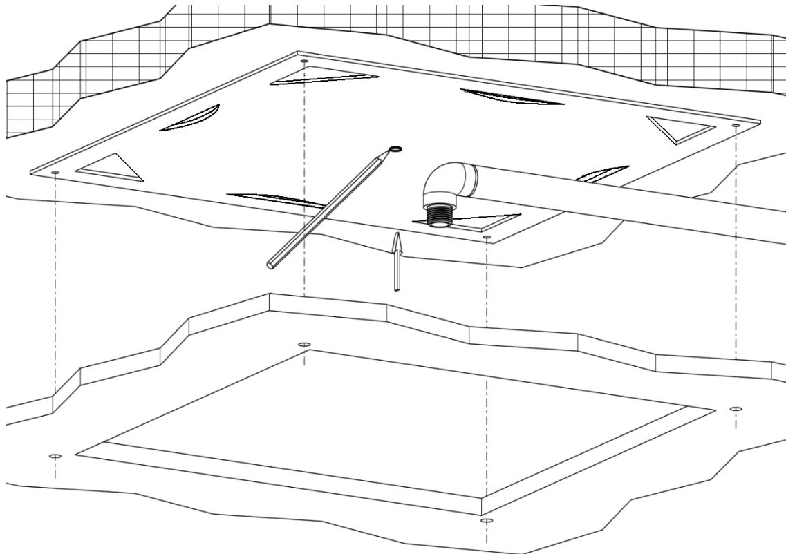
Posizionare la dima in cartone sul soffitto come indicato in figura. Tracciare la posizione del foro di fissaggio.
