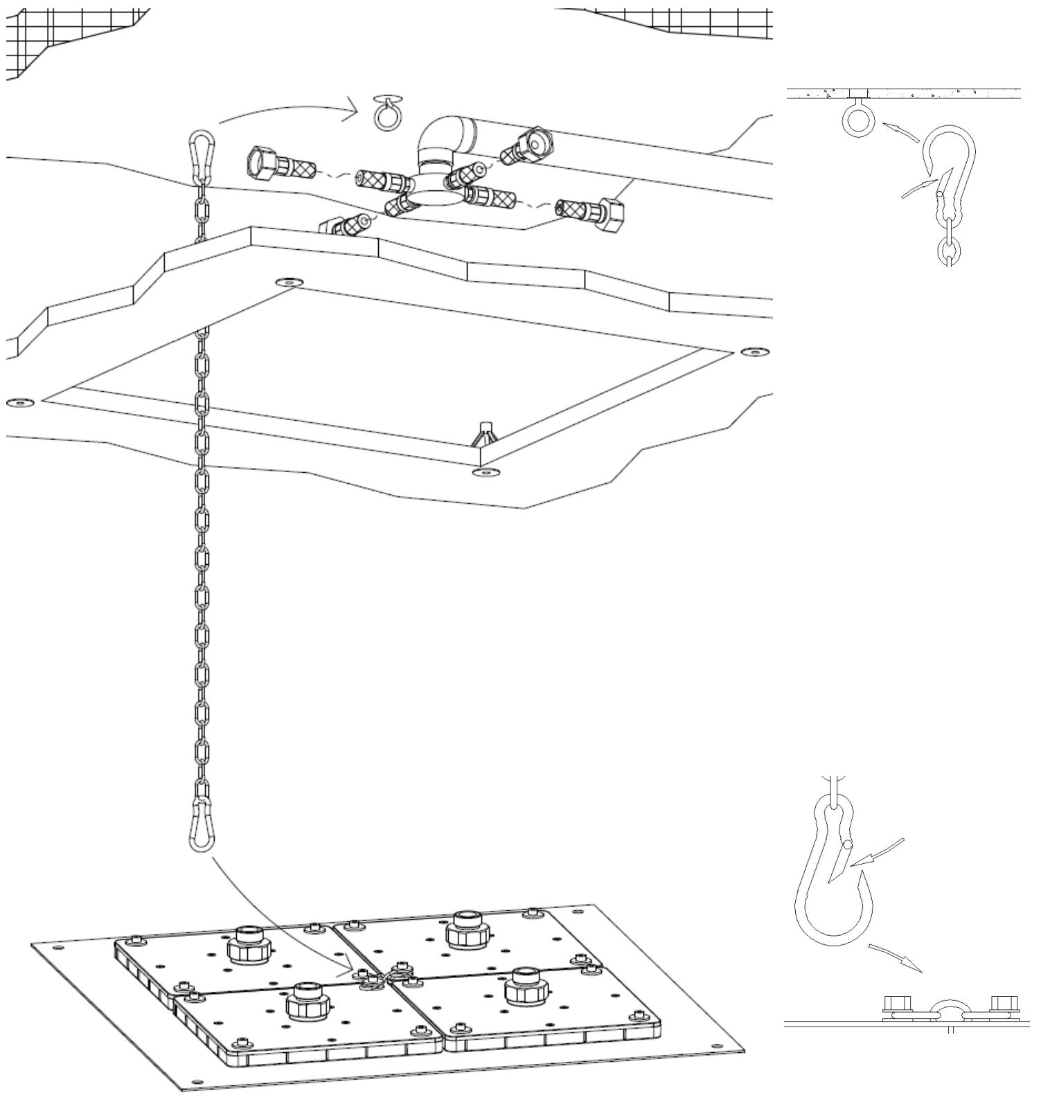
Agganciare la catena di sicurezza al punto di ancoraggio a soffitto e fissare il soffione alla catena.
