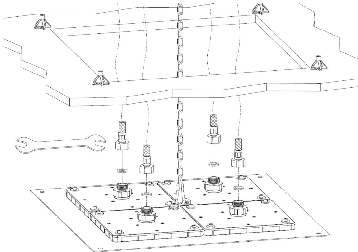
Collegare il soffione all'impianto serrando a tenuta i flessibili in dotazione con chiave da 23mm anteponendo le guarnizioni. Attenzione, prima di ultimare l'installazione, verificare che l'impianto sia perfettamente a tenuta d'acqua.
