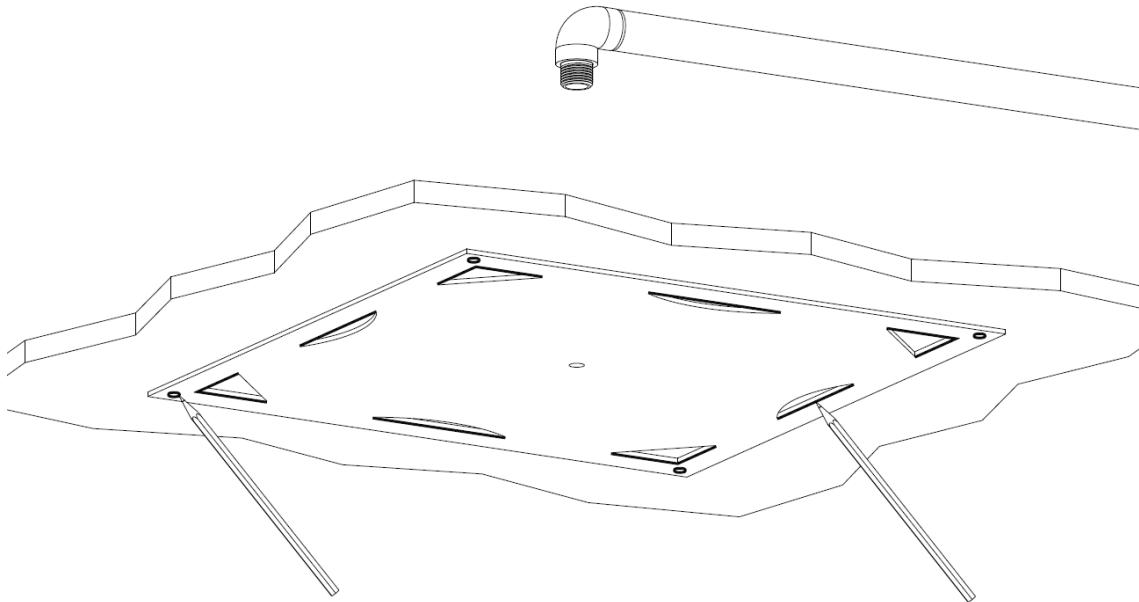
Tracciare la posizione dello scasso e dei fori di fissaggio.
