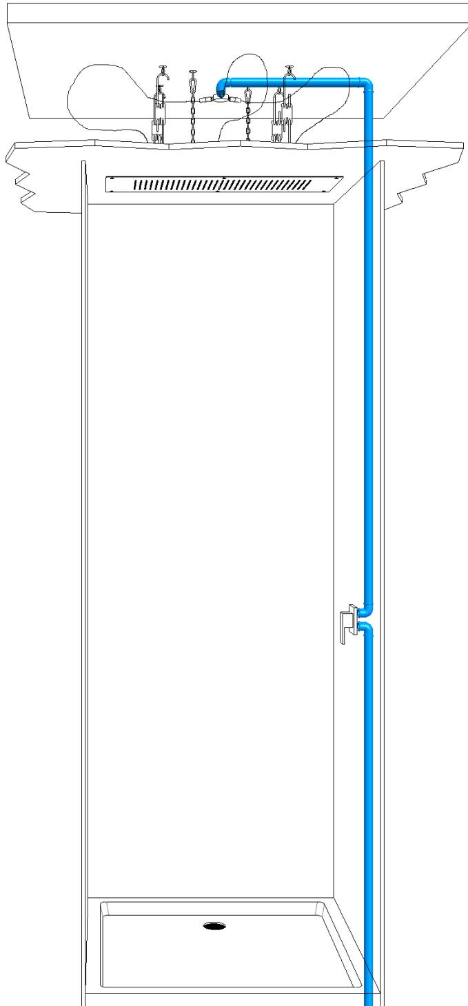
Predisporre un collegamento a soffitto con uscita M1/2"G (EUR) o M1/2"NPT (USA) in prossimità della futura sede del soffione e un controsoffitto rinforzato avente uno spessore compreso tra 7 e 21 mm posto ad una distanza dal soffitto non inferiore a 10 cm.
