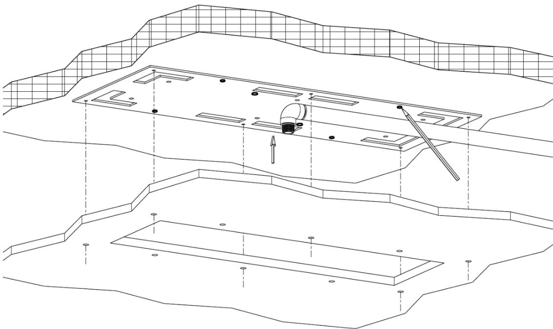
Posizionare la dima in cartone sul soffitto come indicato in figura. Tracciare la posizione dei fori di fissaggio.
