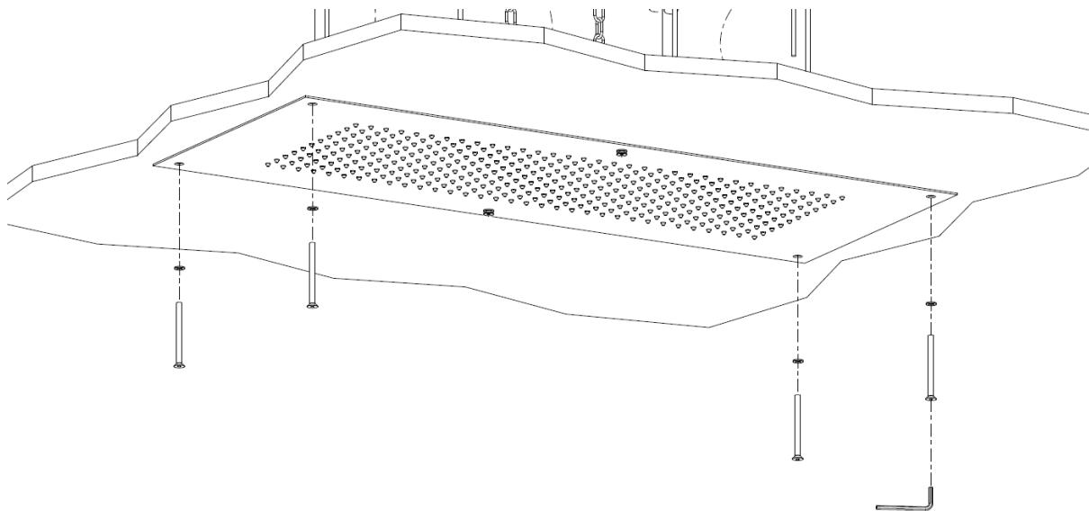
Fissare il soffione serrando le viti a testa svasata rimanenti con chiave a brugola da 3 mm interponendo le rondelle.
