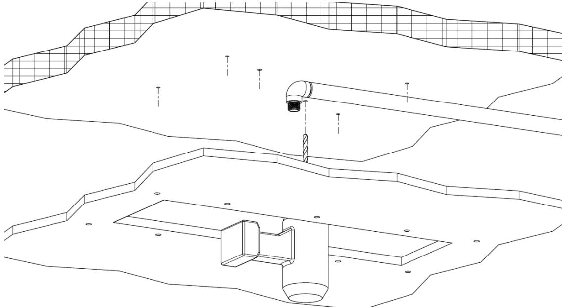
Forare con punta Ø8 il soffitto in funzione della traccia eseguita al punto precedente.
