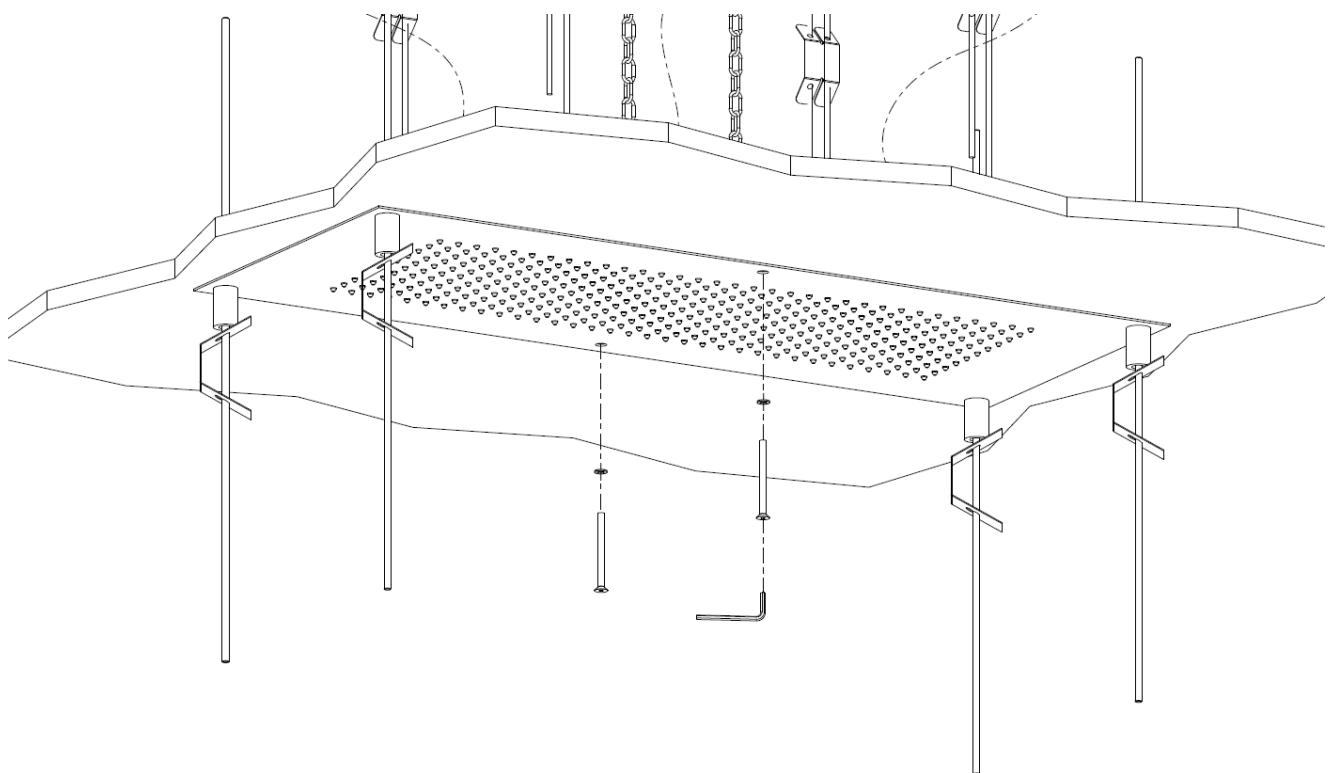
Fissare il soffione serrando le 2 viti a testa svasata fornite con chiave a brugola da 3 mm interponendo le rondelle.
