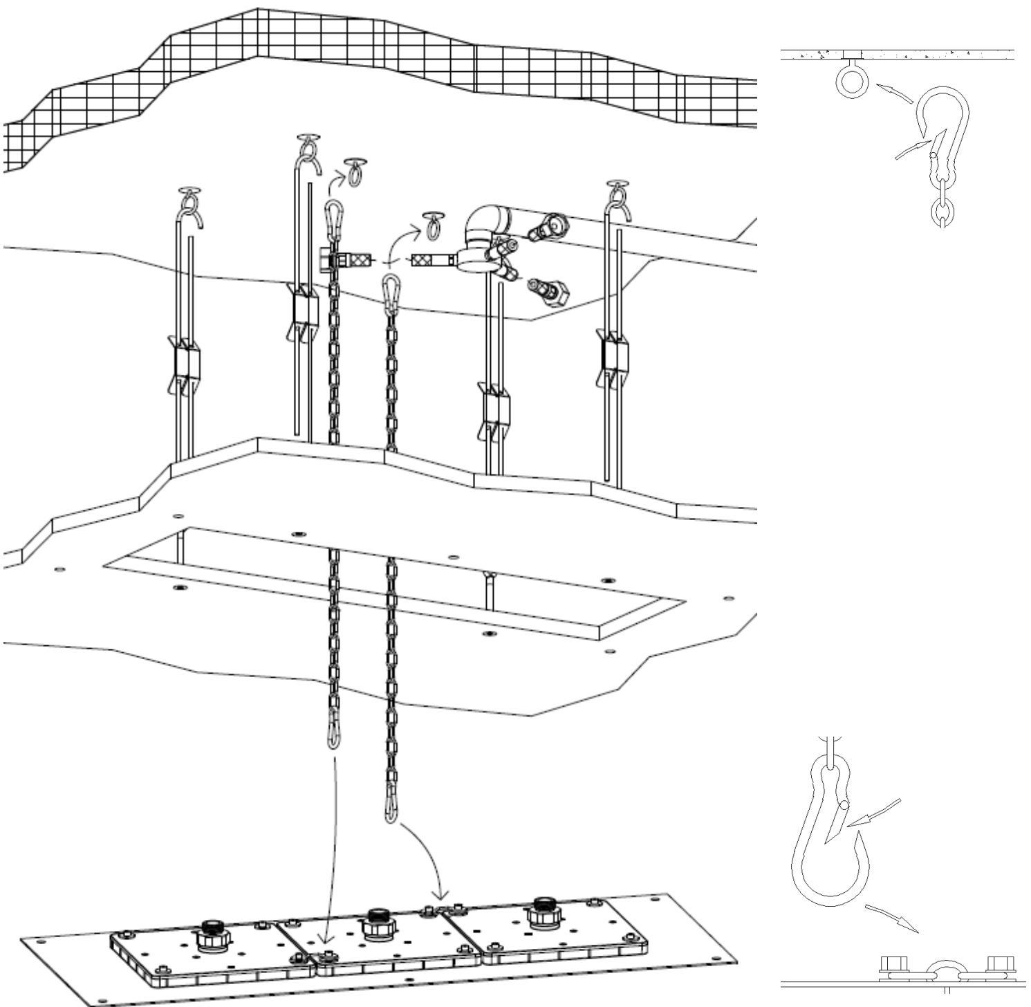
Agganciare le catene di sicurezza ai punti di ancoraggio a soffitto e fissare il soffione alle catene.
