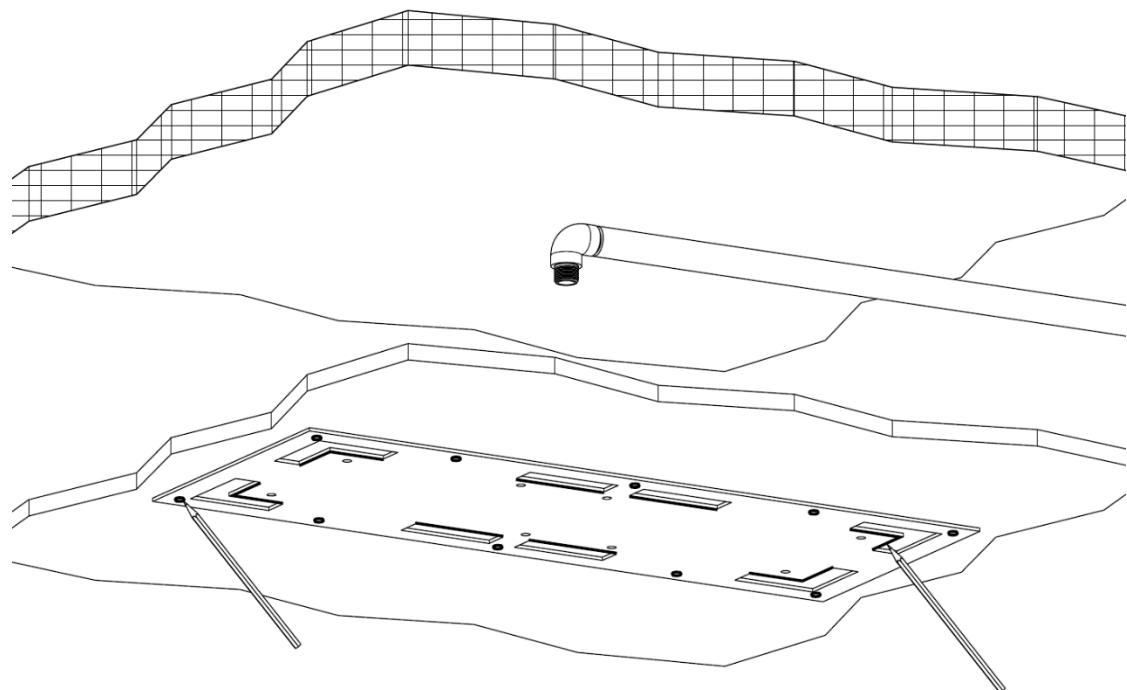
Tracciare la posizione dello scasso e dei fori di fissaggio.
