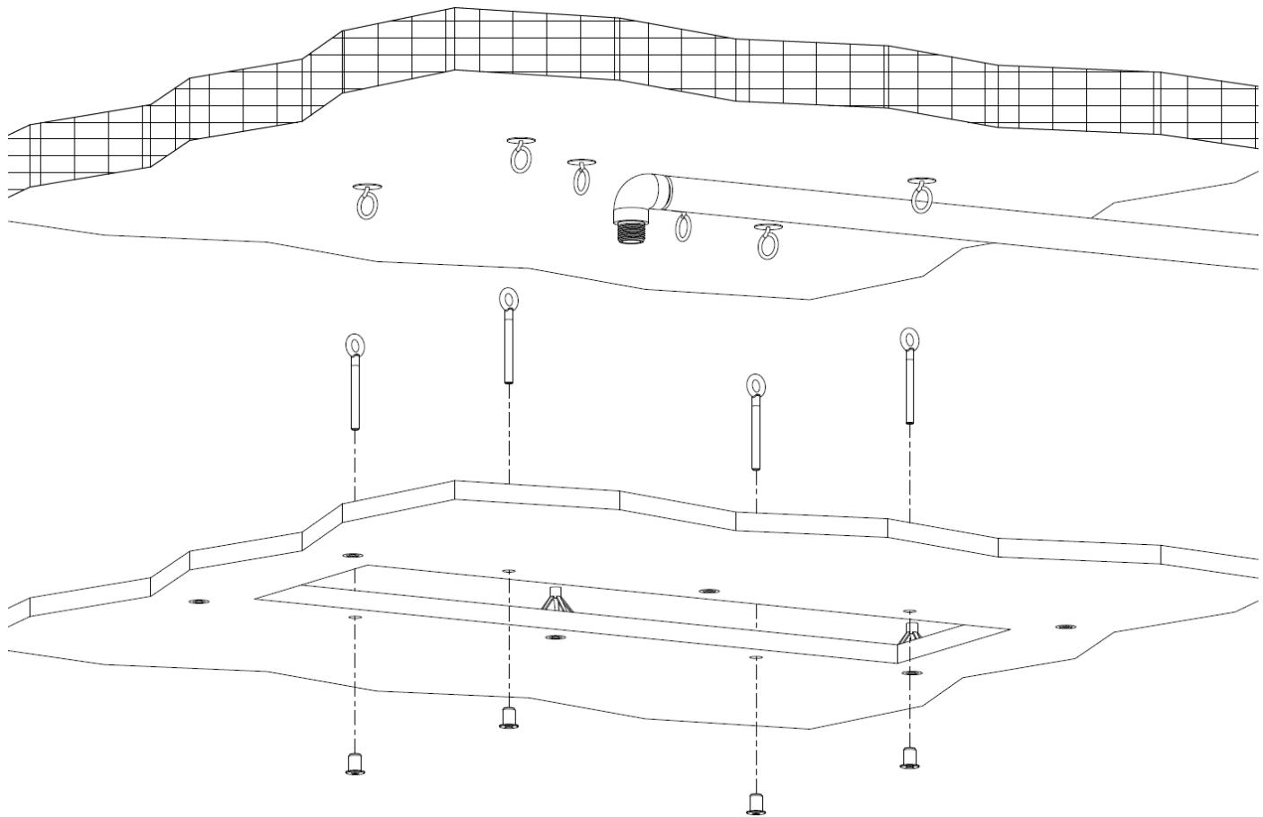
Avvitare sul cartongesso i raccordi di sostegno e i tiranti come illustrato in figura.
