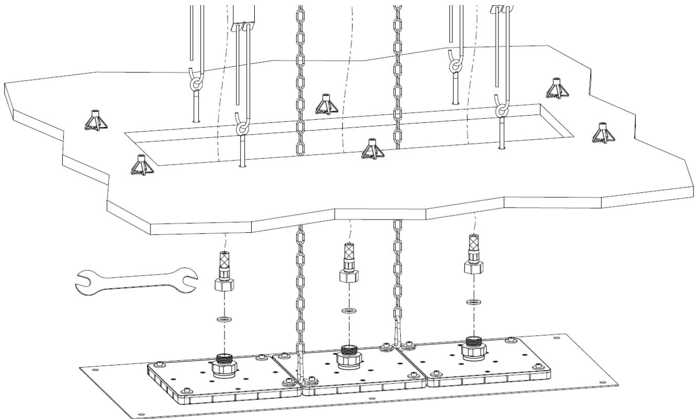
Collegare il soffione all'impianto serrando a tenuta i flessibili in dotazione con chiave da 23mm anteponendo le guarnizioni. Attenzione, prima di ultimare l'installazione, verificare che l'impianto sia perfettamente a tenuta d'acqua.
