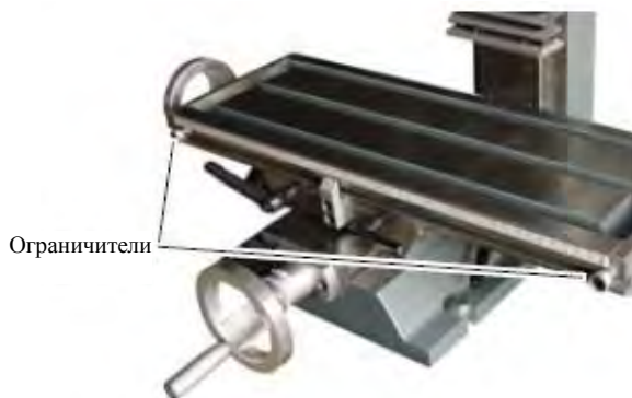
Рис. 4-11: Ограничители хода по оси X
