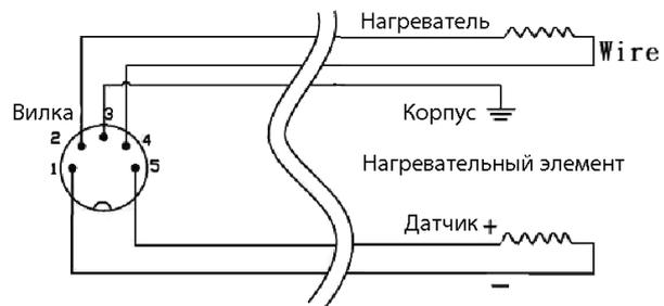
Схема нагревательного элемента
