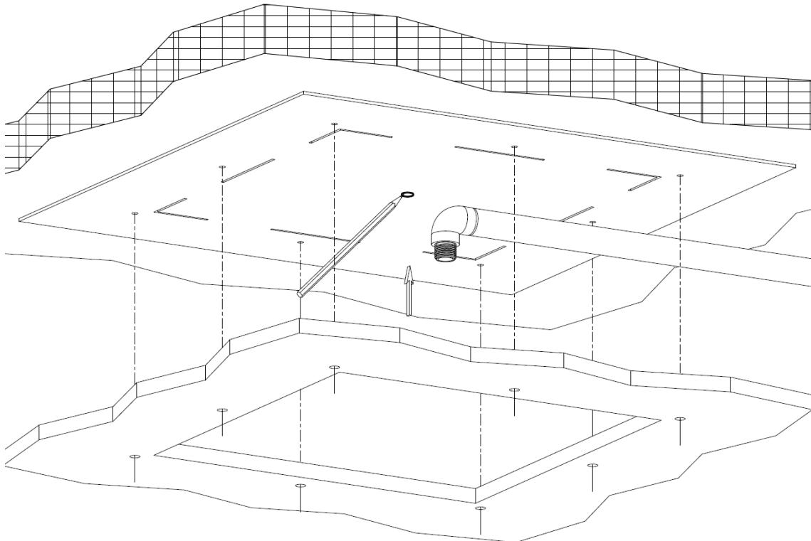
Posizionare la dima in cartone sul soffitto come indicato in figura. Tracciare la posizione del foro di fissaggio.
