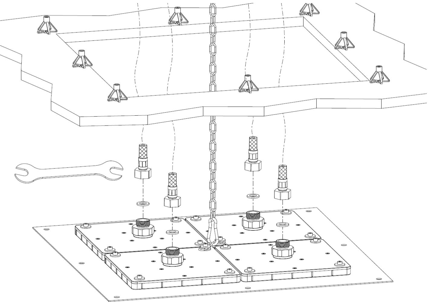
Collegare il soffione all'impianto serrando a tenuta i flessibili in dotazione con chiave da 23mm anteponendo le guarnizioni.
