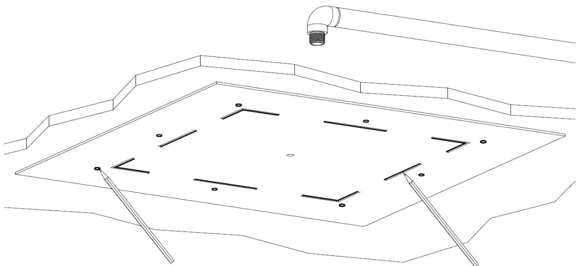
Tracciare la posizione dello scasso e dei fori di fissaggio.
