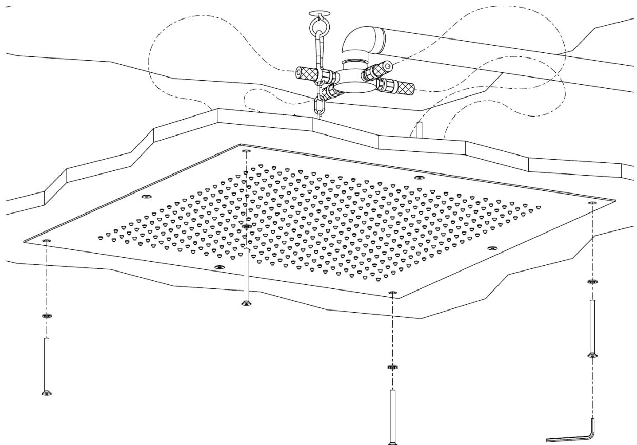
Fissare il soffione serrando le viti a testa svasata rimanenti con chiave a brugola da 3 mm interponendo le rondelle.
