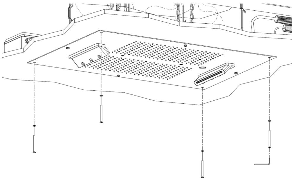
Fissare il soffione serrando le viti a testa svasata rimanenti con chiave a brugola da 3 mm interponendo le rondelle.
