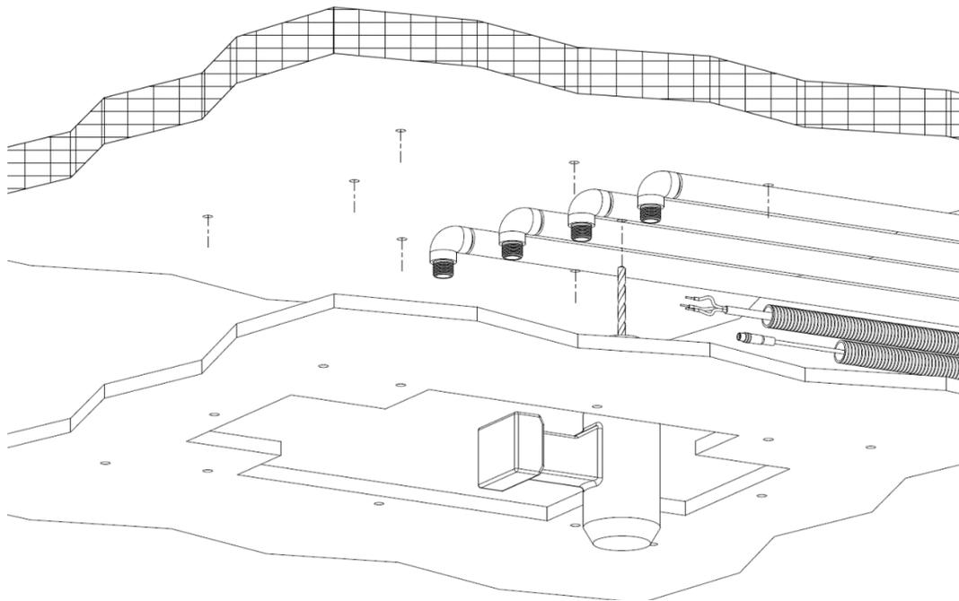
Forare con punta  $\varnothing 8$  il soffitto in funzione della traccia eseguita al punto precedente.
