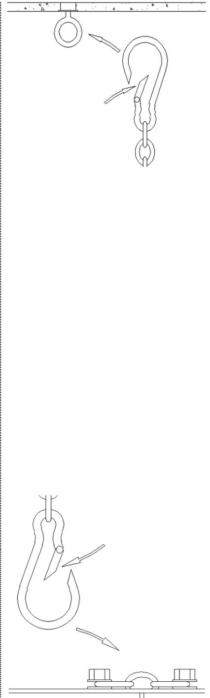
Agganciare le catene di sicurezza ai punti di ancoraggio a soffitto e fissare il soffione alle catene. Così facendo il soffione è "in sicurezza".
