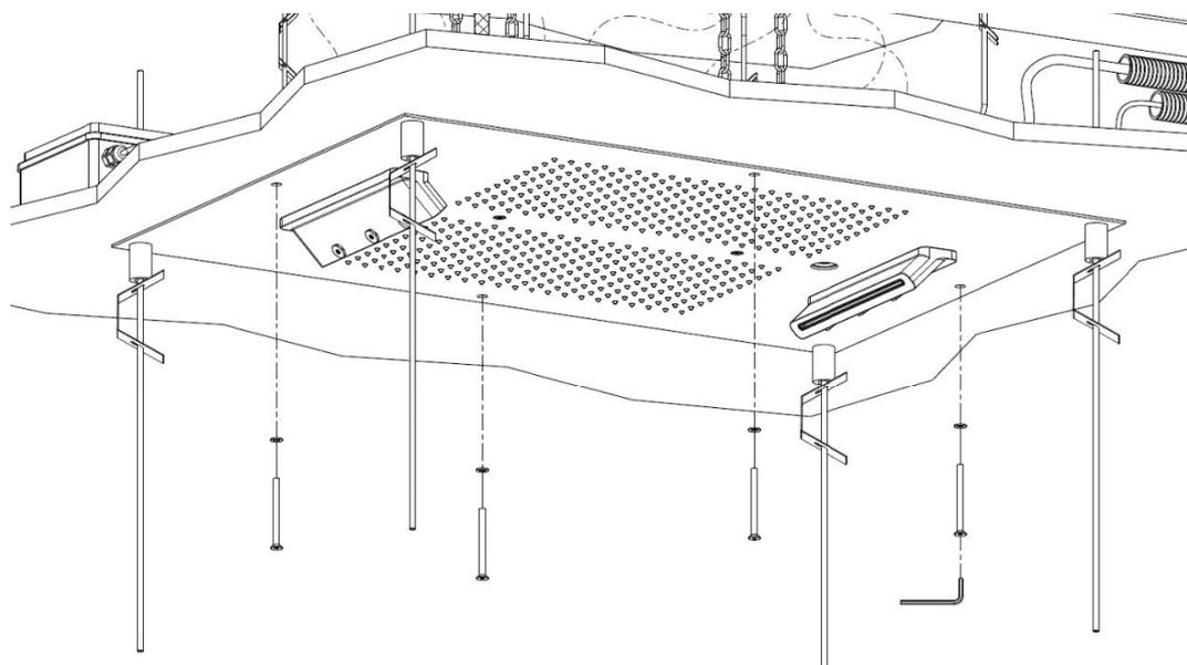
Fissare il soffione serrando le 4 viti a testa svasata fornite con chiave a brugola da 3 mm interponendo le rondelle.
