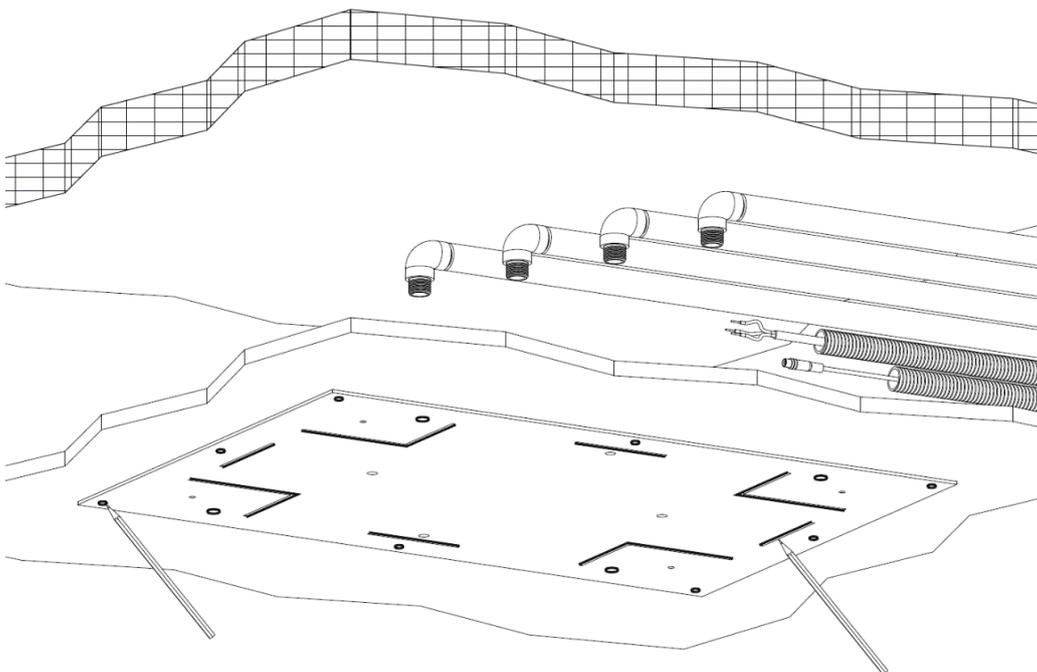
Tracciare la posizione dello scasso e dei fori di fissaggio (seguendo la dima in dotazione).
