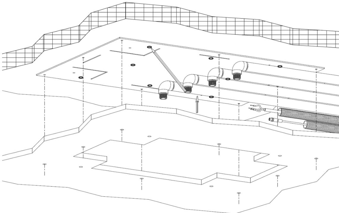
Posizionare la dima in cartone sul soffitto come indicato in figura. Tracciare la posizione dei fori di fissaggio.
