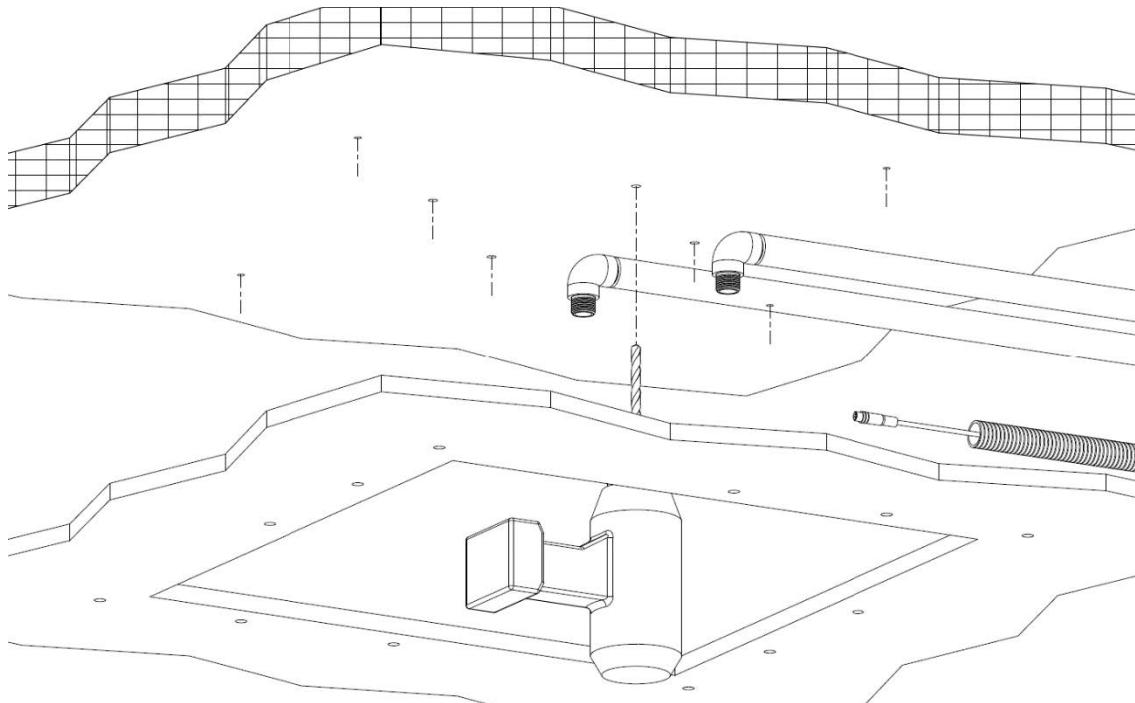
Forare con punta Ø8 il soffitto in funzione della traccia eseguita al punto precedente.
