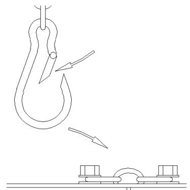
Aggiicare le catene di sicurezza ai punti di ancoraggio a soffitto e fissare il soffione alle catene.
