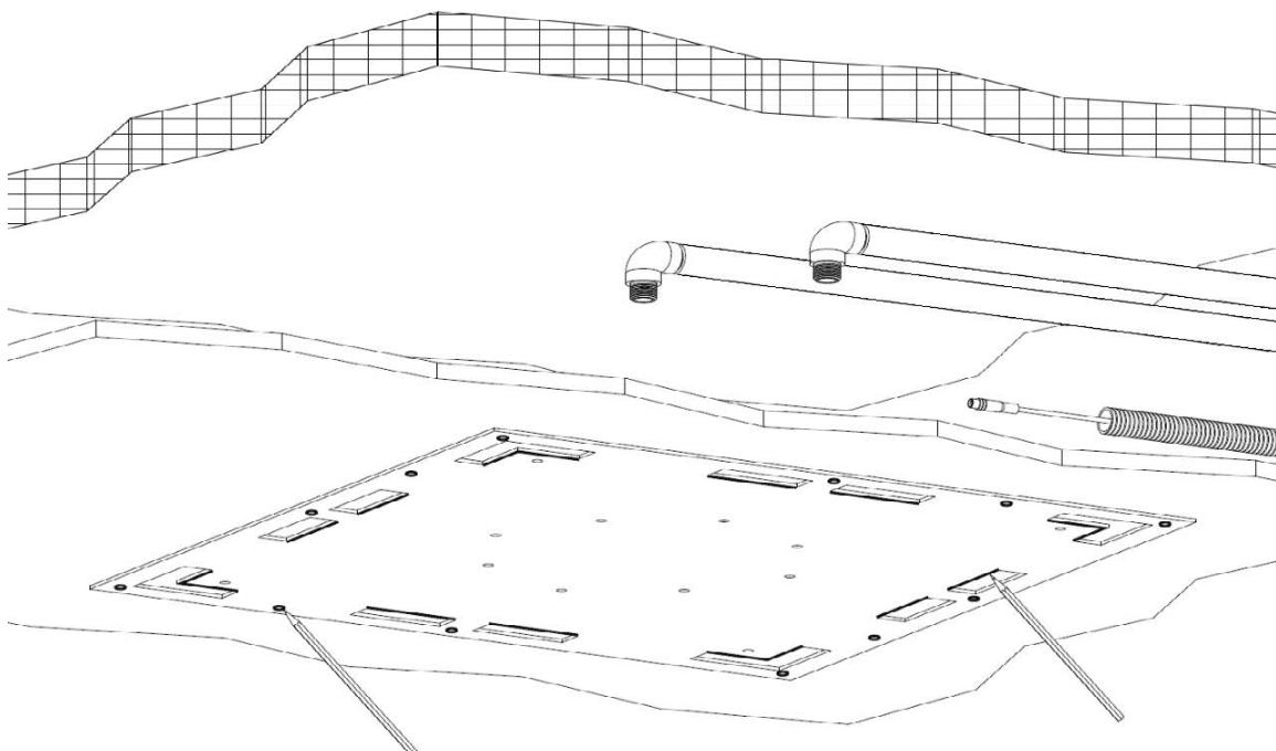
Tracciare la posizione dello scasso e dei fori di fissaggio.
