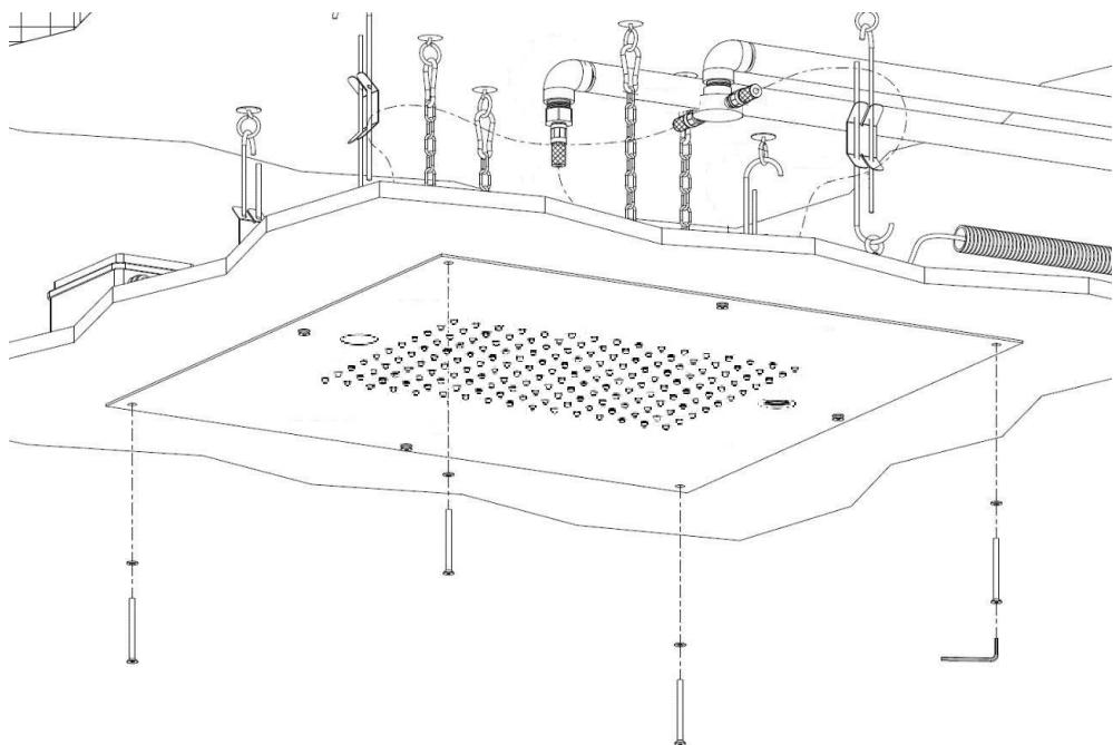
Fissare il soffione serrando le viti a testa svasata rimanenti con chiave a brugola da 3 mm interponendo le rondelle.
