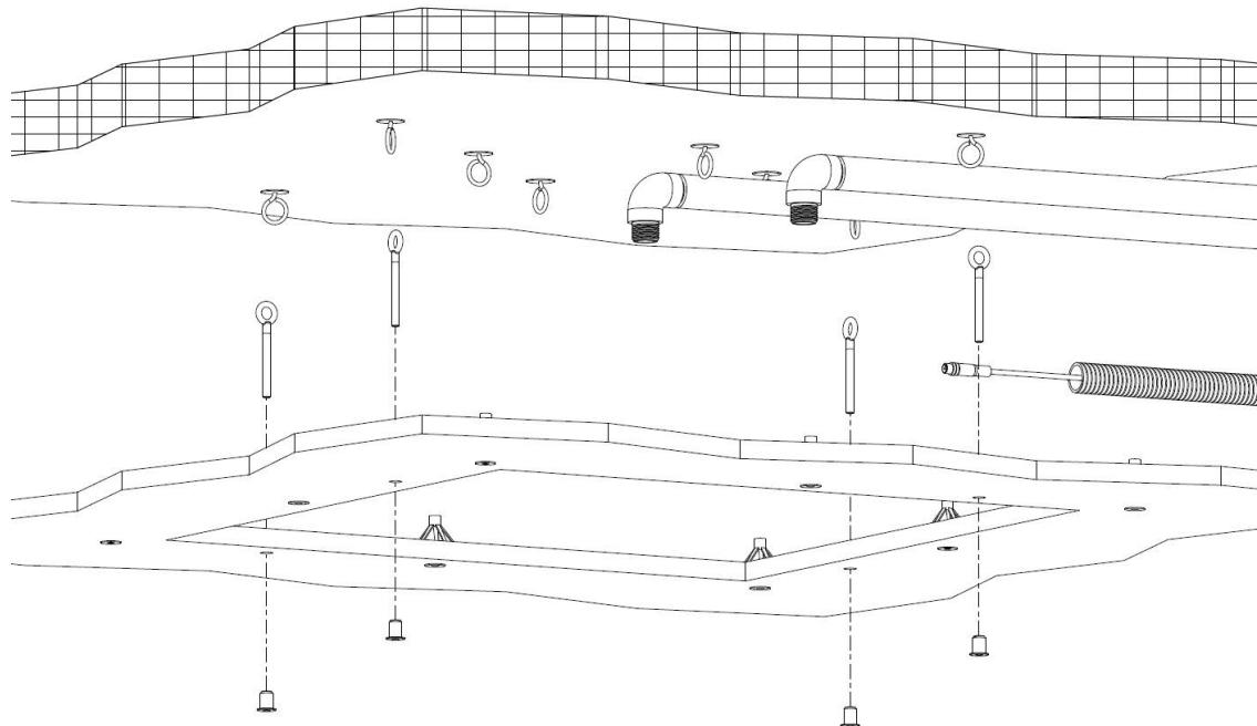
Avvitare sul cartongesso i raccordi di sostegno e i tiranti come illustrato in figura.
