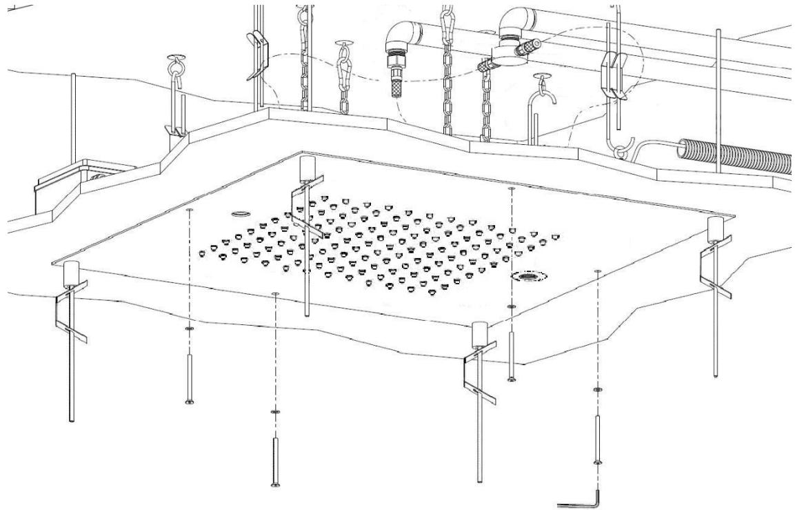
Fissare il soffione serrando le 4 viti a testa svasata fornite con chiave a brugola da 3 mm.
