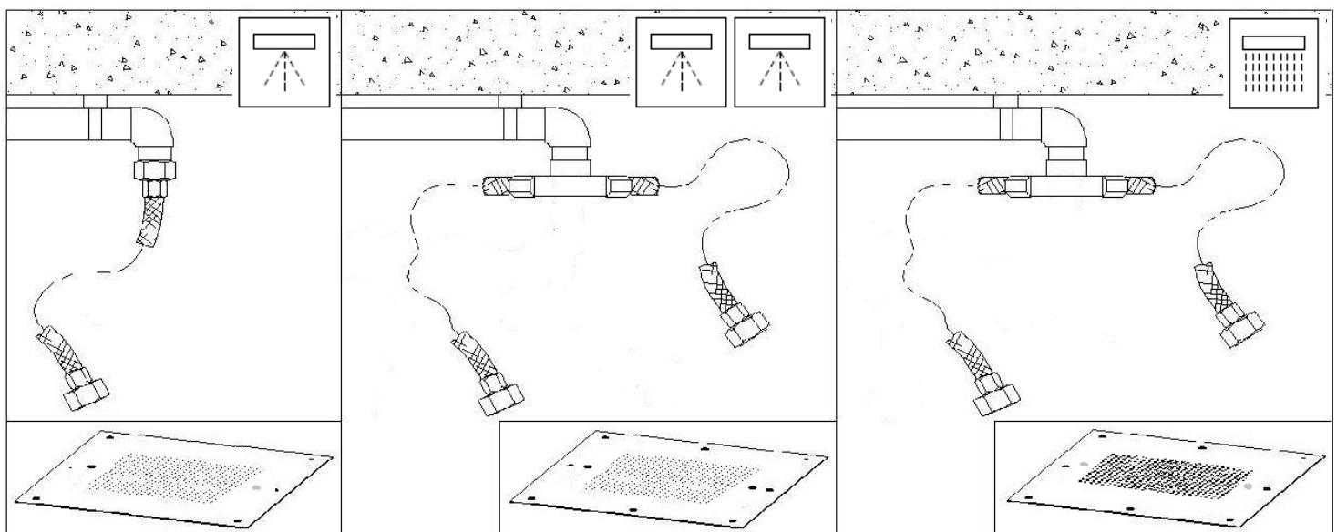
Collegare il soffione all'impianto serrando a tenuta i flessibili in dotazione con chiave da 23mm anteponendo le guarnizioni. Attenzione, prima di ultimare l'installazione, verificare che l'impianto sia perfettamente a tenuta d'acqua.
