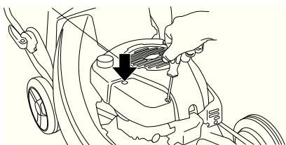
Αφαιρέστε το φίλτρο αέρα και ελέγξτε ότι δεν παρουσιάζει βλάβες. Αντικαταστήστε με ένα νέο φίλτρο αέρα, αν πιστεύετε ότι είναι ελαττωματικό.
