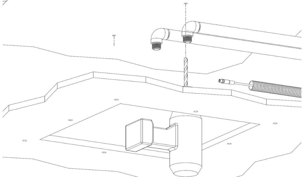
Forare con punta Ø8 il soffitto in funzione della traccia eseguita al punto precedente.
