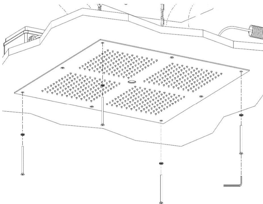
Fissare il soffione serrando le viti a testa svasata rimanenti con chiave a brugola da 3 mm.
