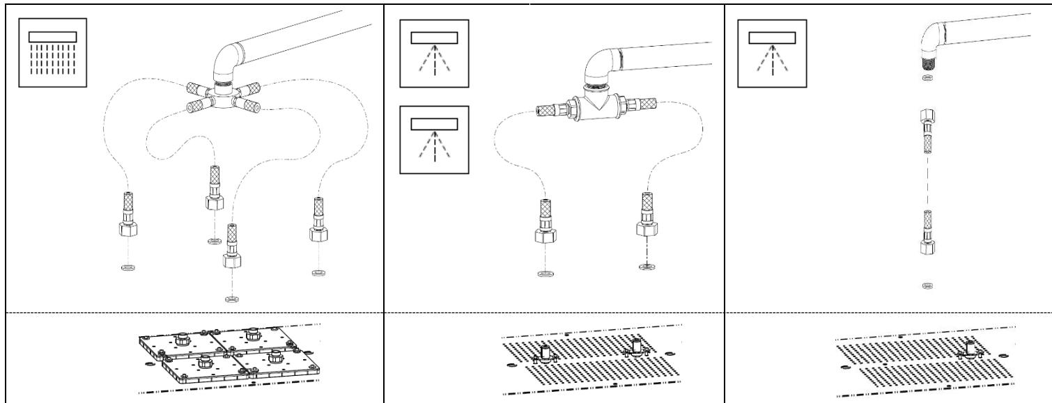
Collegare il soffione all'impianto serrando a tenuta i flessibili in dotazione con chiave da 23mm anteponendo le guarnizioni. Attenzione, prima di ultimare l'installazione, verificare che l'impianto sia perfettamente a tenuta d'acqua.
