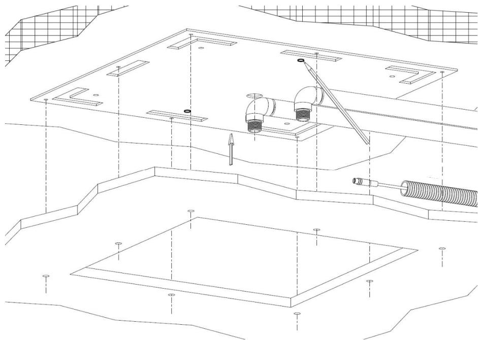
Posizionare la dima in cartone sul soffitto come indicato in figura. Tracciare la posizione dei fori di fissaggio.
