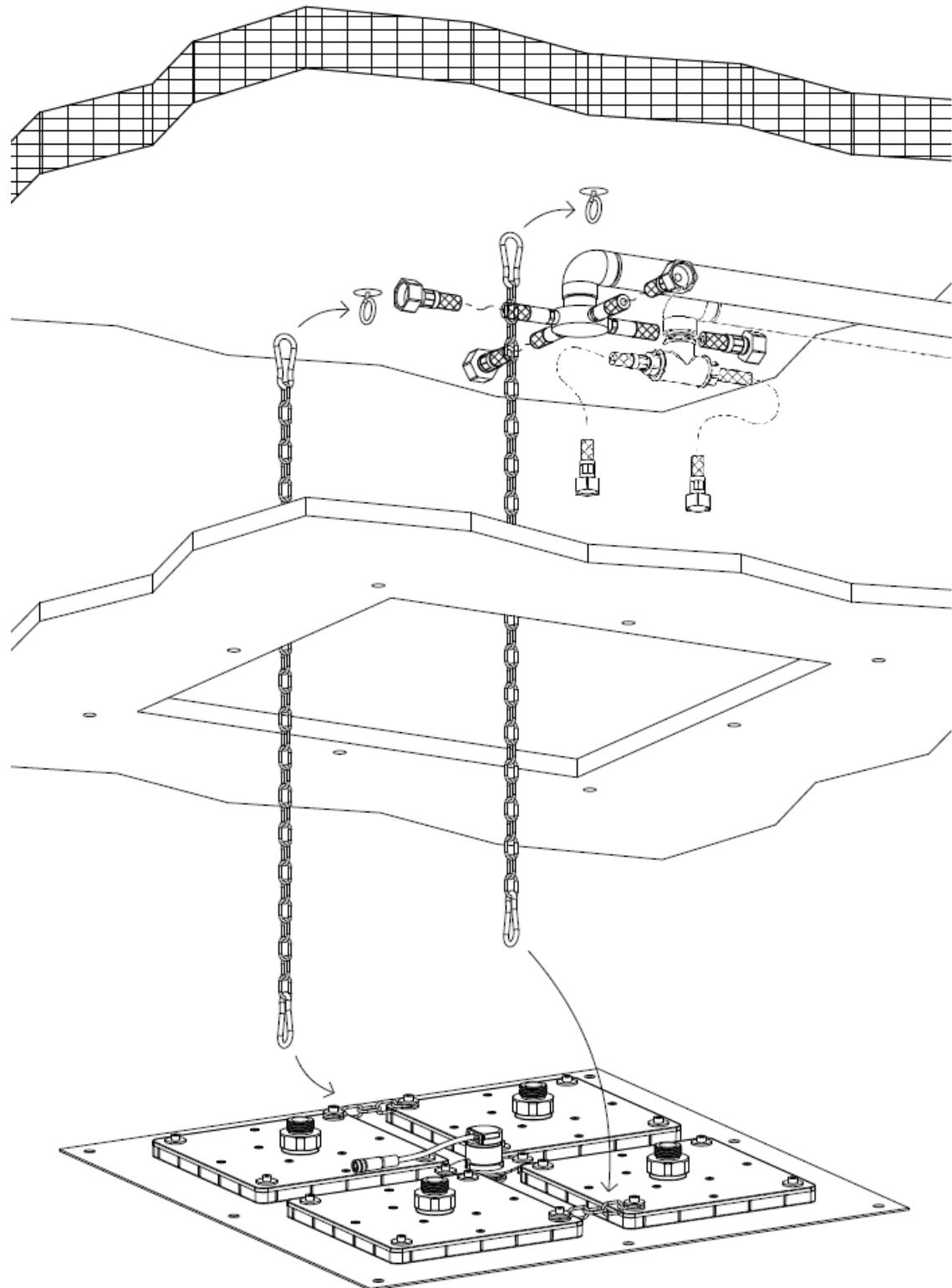
Agganciare la catena di sicurezza al punto di ancoraggio a soffitto e fissare il soffione alla catena. Così facendo il soffione è “in sicurezza”.
