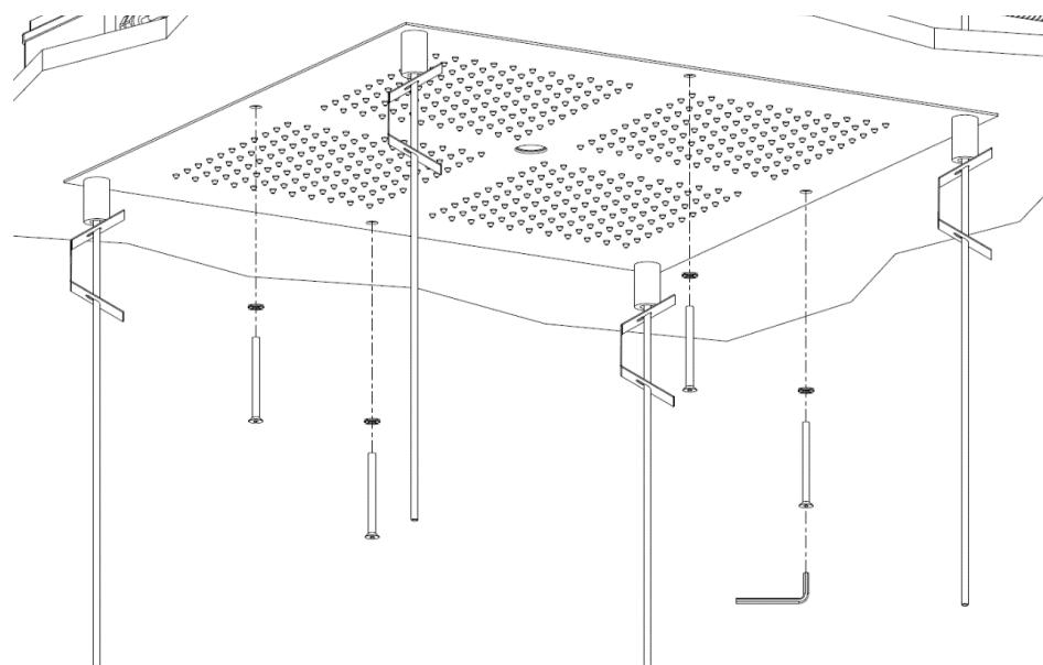
Fissare il soffione serrando le 4 viti a testa svasata fornite con chiave a brugola da 3 mm interponendo le rondelle.
