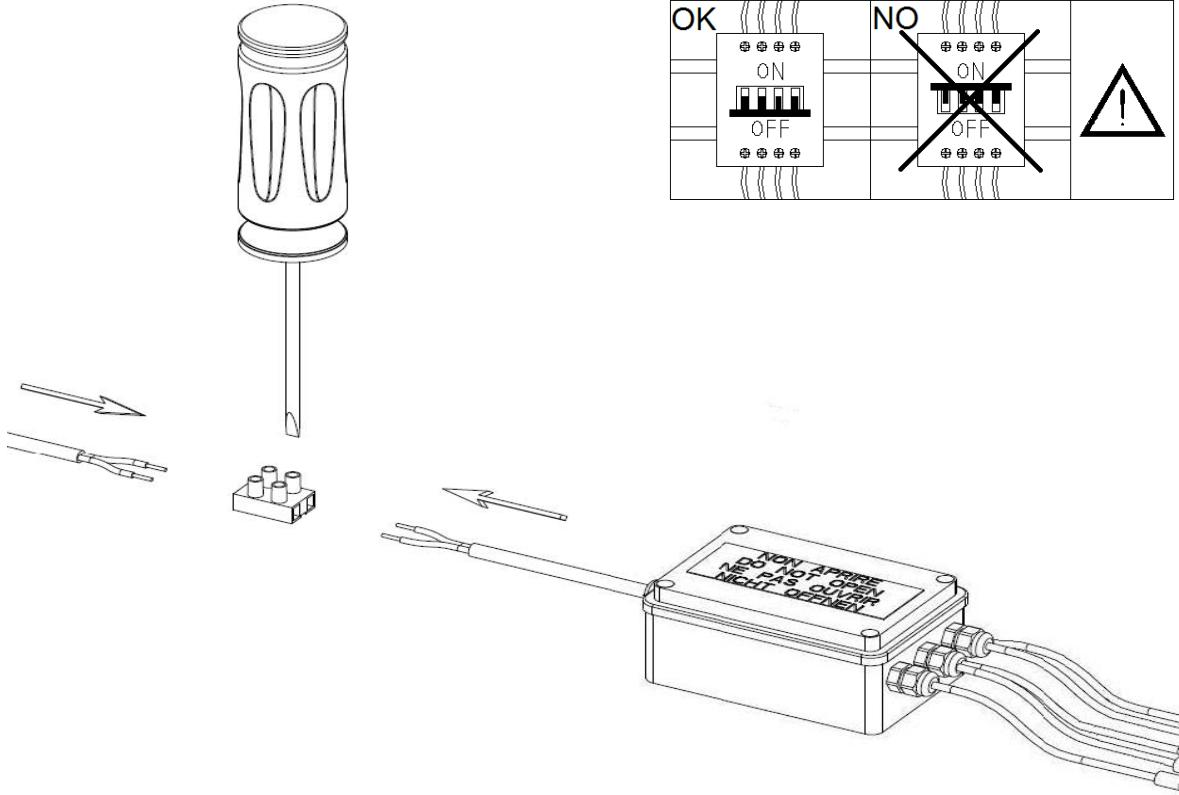
Assicurarsi che non vi sia corrente all'interno dell'impianto elettrico e in seguito collegare la centralina alla linea elettrica utilizzando un morsetto 2 poli.
