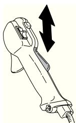
Проверьте, чтобы ручка газа и блокировочный рычаг перемещались свободно и чтобы возвратные пружины работали соответствующим образом.
