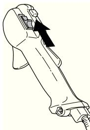
Запустите двигатель и проверьте, чтобы он остановился при переводе выключателя в положение стоп.
