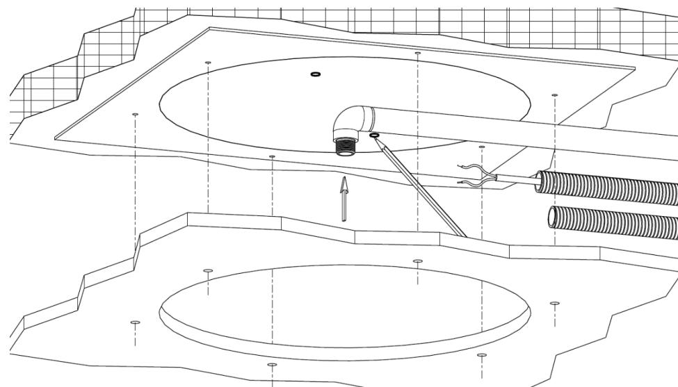
Posizionare la dima in cartone sul soffitto come indicato in figura. Tracciare la posizione del foro di fissaggio.
