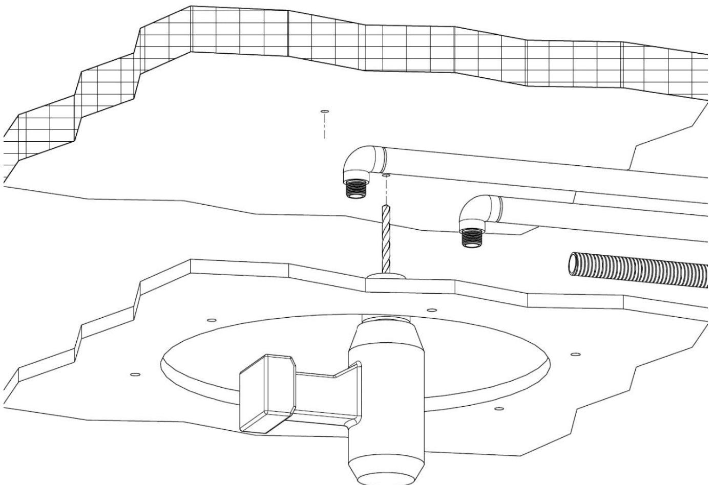
Forare con punta Ø8 il soffitto in funzione della traccia eseguita al punto precedente.
