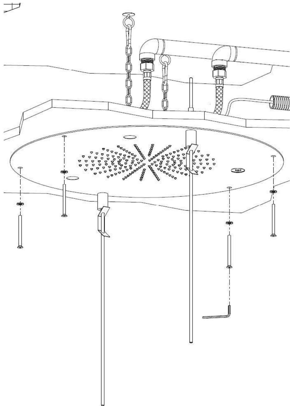
Fissare il soffione serrando le 4 viti a testa svasata fornite con chiave a brugola da 3 mm interponendo le rondelle.
