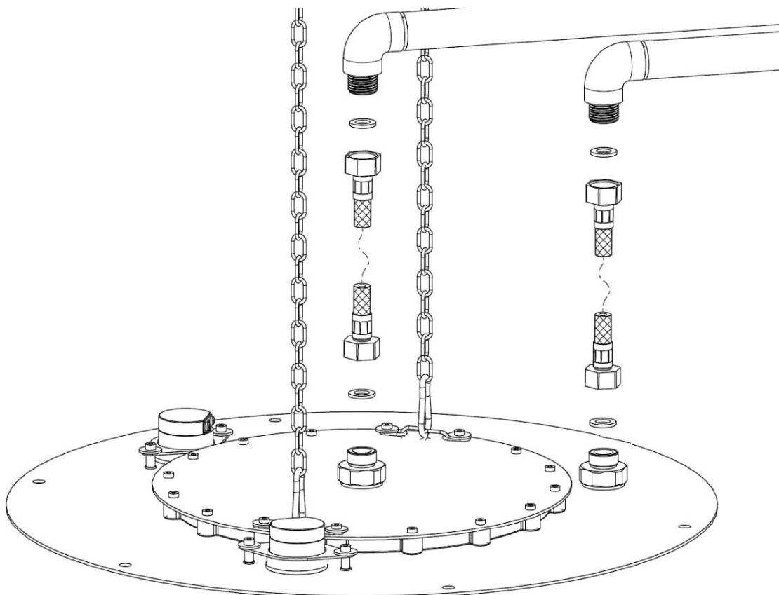
Collegare il soffione all'impianto serrando a tenuta il flessibile in dotazione con chiave da 23 mm anteponendo le guarnizioni.
