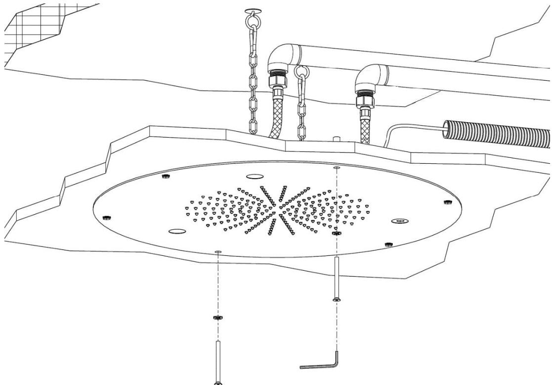
Fissare il soffione serrando le viti a testa svasata rimanenti con chiave a brugola da 3 mm.
