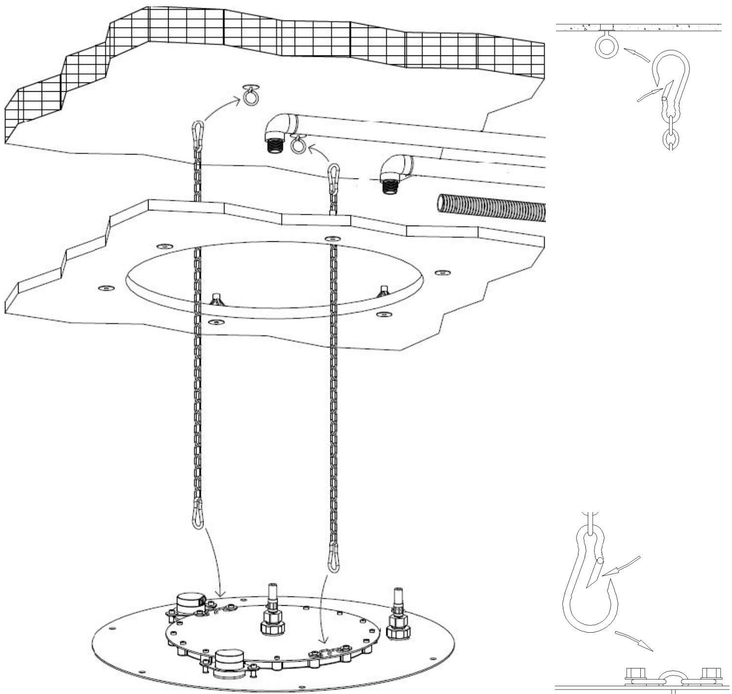
Aggiicare le catene di sicurezza ai punti di ancoraggio a soffitto e fissare il soffione alle catene.
