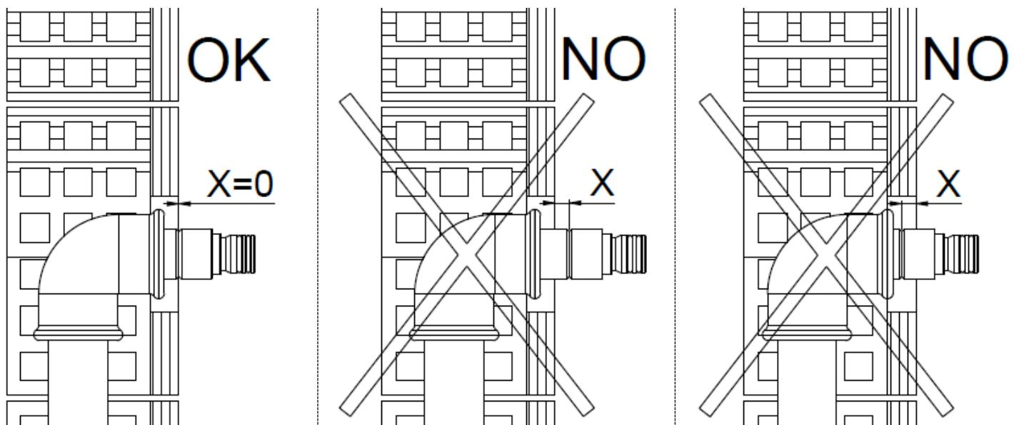
A rivestimento ultimato collegare il raccordo da G1/2" M (A) all'impianto con chiave a brugola da 6 mm serrandolo a tenuta utilizzando canapa o similari.
