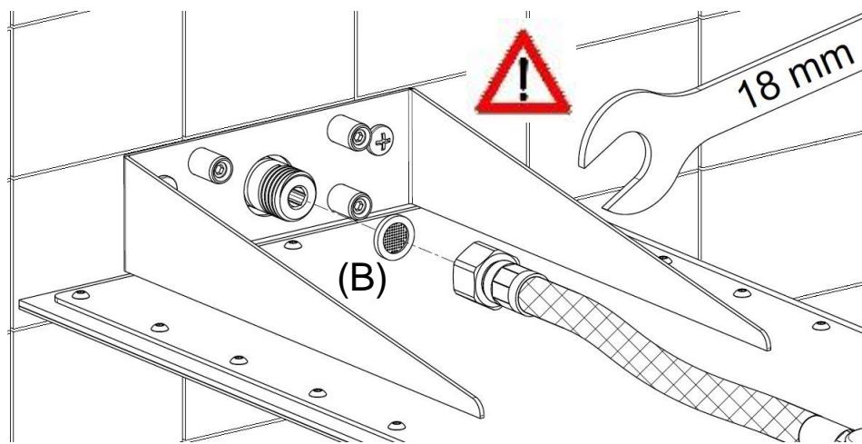
Avvitare a tenuta il flessibile sul raccordo a muro con chiave da 18 mm anteponendo la guarnizione (B).
