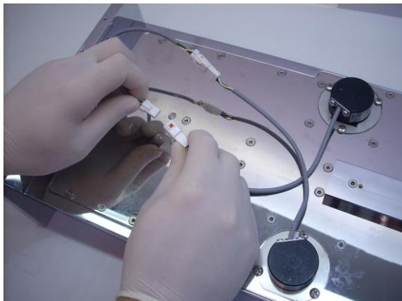
Fissare il supporto copri cavo avvitando le due viti con chiave a brugola da 2 mm.
