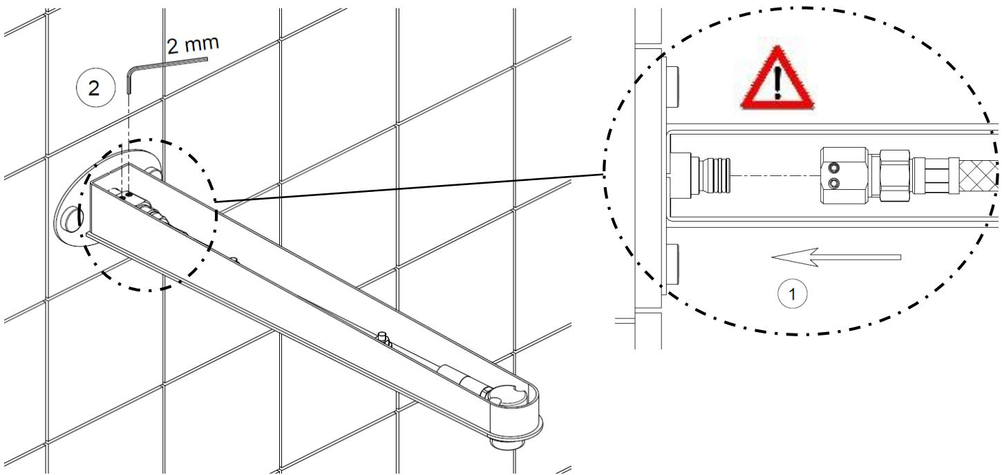
Calzare il flessibile sul raccordo a muro prestando attenzione a non pizzicare gli o-ring e bloccarlo con i grani utilizzando una chiave a brugola da 2 mm.
