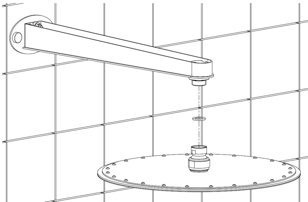
Completere il braccio avvitando il soffione, verificando la presenza della guarnizione di tenuta.
