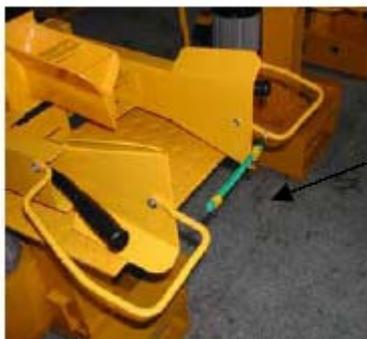
Специальная стропа фиксирует рукоятки во время транспортировки.
