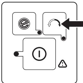
При нажатии кнопки вращения загорится зеленый светодиод и головка триммера будет вращаться против часовой стрелки. По умолчанию головка триммера вращается по часовой стрелке (когда зеленый светодиод не горит).
