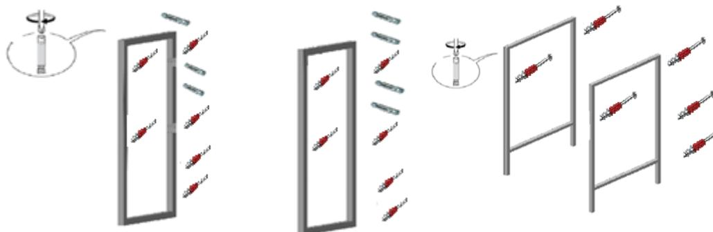
3. Произведите установку полок, совмещая отверстия в полках (п.3.4.5) с установленными штоками. (п.8)
