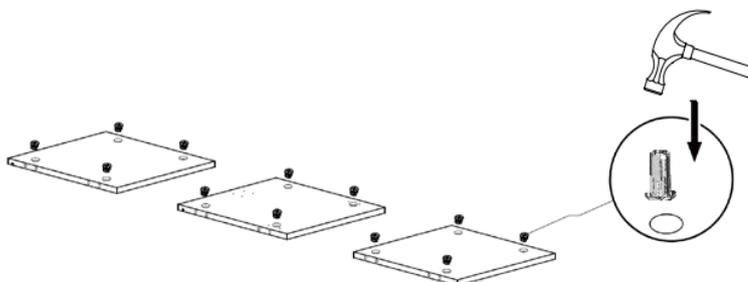
2. Закрутите шток (п.8,12) в металлические рамы (п.1.2.6.7) и установите отверстие таким образом, чтобы втулка закручивалась по ходу движения.
