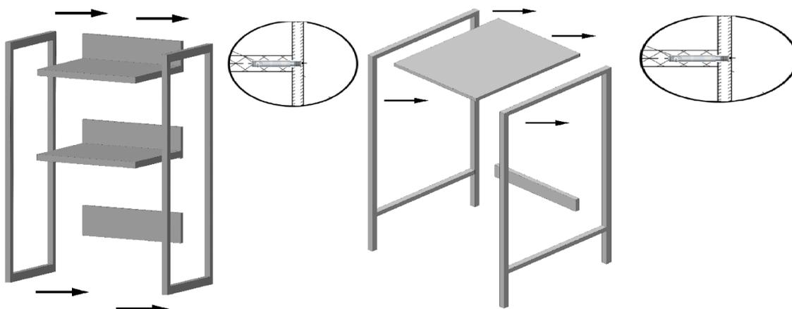
4. Закрутите винт-конический (п.10) и эксцентрик (п.11) с нижней стороны полок (п.3.5.) в уже установленные муфты (п.9)
