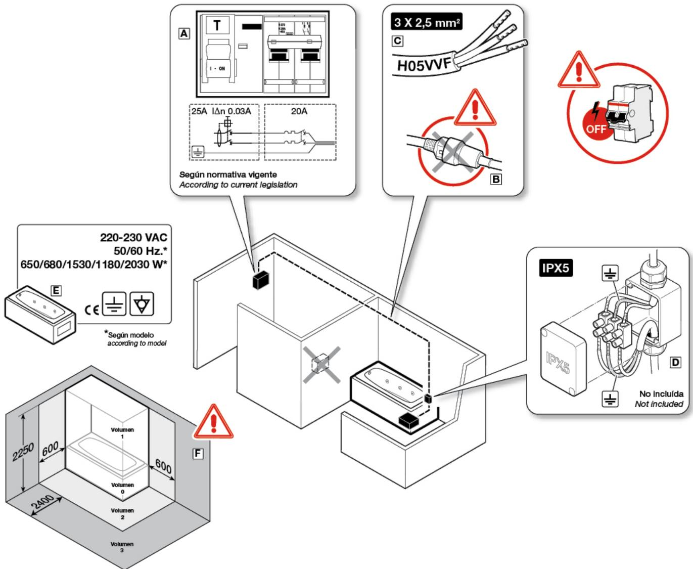
**ES** **A** La instalación eléctrica debe protegerse mediante un interruptor diferencial de  $I\Delta n$  0,03A y 25A de potencia y de un interruptor magnetotérmico de 20A, situado fuera de los volúmenes del cuarto de baño.
