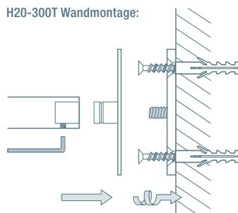
\*Edelstahl-Senkkopfschraube d 7 x 60 mm mit Rahmendübel 10 mm (HRD-CR 10 x 60).
