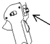
Залейте бензин в карбюратор медленным нажатием кнопки подкачки несколько раз до тех пор, пока бензин не поступит в карбюратор.
