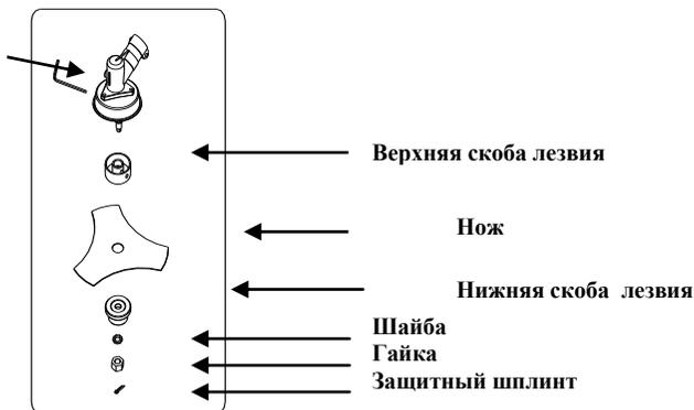
Выньте шплинт, открутите гайку по часовой стрелке (в правую сторону) и снимите нижнюю скобу лезвия.
