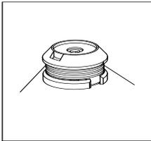
Прикрутите триммерную катушку против часовой стрелки (в левую сторону) по резьбе штока в конце приводной части. Зафиксируйте шток на месте, вставив отвёртку или ключ-шестигранник в отверстие в верхнем зажиме насадки и крепко затянув катушку.
