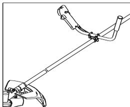
Возьмите ручку и установите её в специальную скобу для ручки. Слегка затяните скобу для ручки при помощи 4 крепёжных винтов, поставляемых в комплекте. Прикрепите ручку на шток в удобную рабочую позицию, затем туго затяните крепёжные винты.
