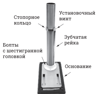
Рис. 2. Установка стойки в сборе на основание
