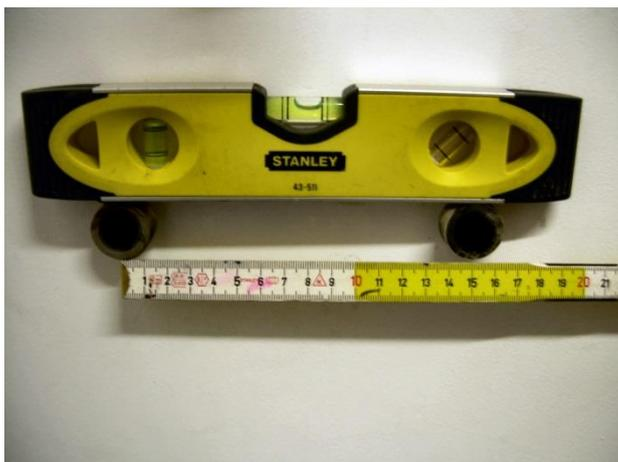
Con l'ausilio di una livella e di un metro, posizionare correttamente in bolla e ad una distanza di 150 mm i raccordi eccentrici.
