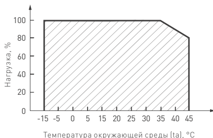
Рис. 2. Максимальная допустимая нагрузка, % от мощности источника.
