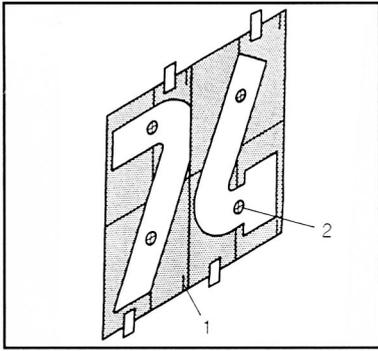
1. Bohrschablone ausrichten, weitere Schablonen an entsprechenden Markierungen (1) oder, Außenkanten anlegen und festkleben. Befestigungspunkte (2) kennzeichnen.
