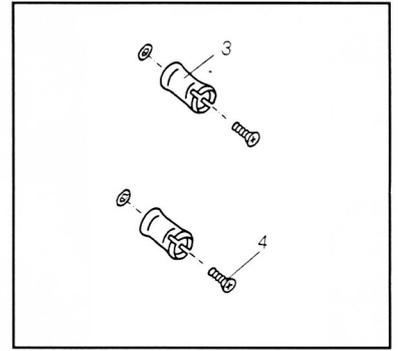
3. Sockel (3) mit Senkschrauben (4) festschrauben.
