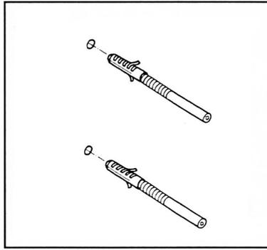
2. Dübellöcher 10 mm  $\varnothing$  bohren. Schrauben ca. 10 mm in den Dübel einschrauben. Dübel mit Schraube durch Putz in das Mauerwerk einstecken, Dübel muß vollständig im Mauerwerk sitzen. Schraube einschrauben bis sie bündig mit dem Putz abschließt.
