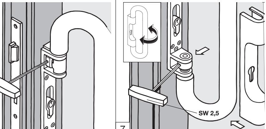
Demontage | Demounting | Démontage | Demontage | Smontaggio | Desmontaje | Demontaż
