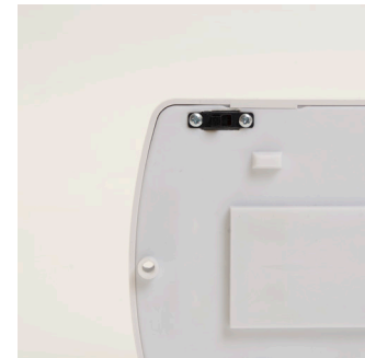
Выключатель аварийного питания
