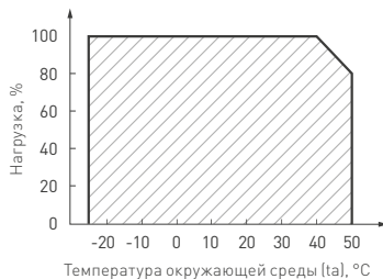
Рис. 2. Максимальная допустимая нагрузка, % от мощности источника
