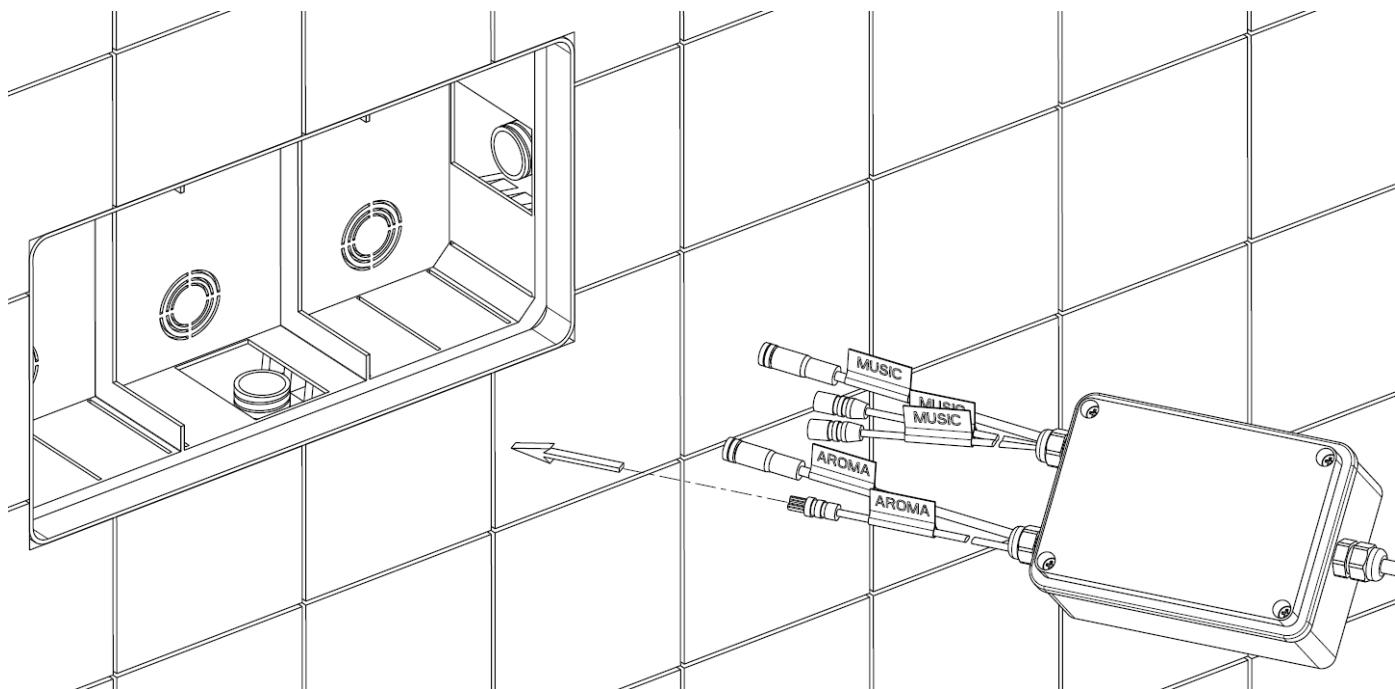
Inserire il cavo della centralina con “**FASSETTA AROMA**” (lunghezza 3 metri) nella canalina proveniente dal diffusore.
