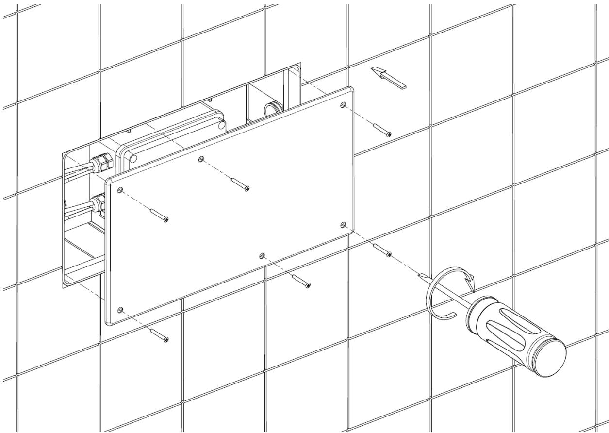
Chiudere la cassetta di derivazione da incasso con il coperchio avvitando le viti con un cacciavite.
