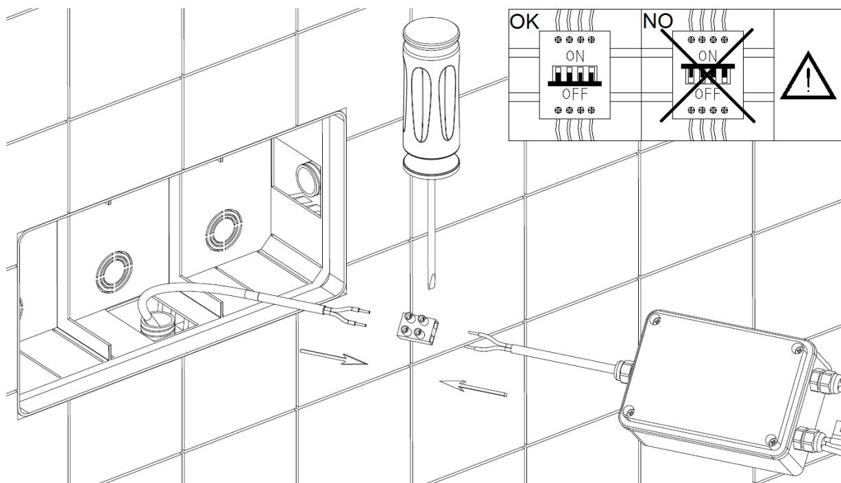
Assicurarsi che non vi sia corrente all'interno dell'impianto elettrico e in seguito collegare la centralina alla linea elettrica utilizzando un morsetto 2 poli.
