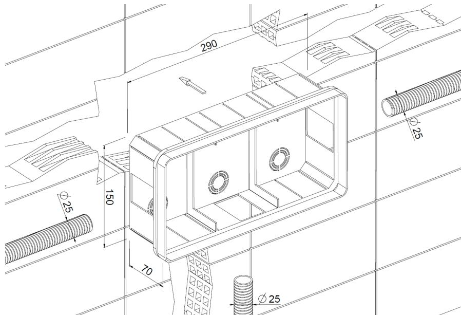
Eseguire uno scasso nel muro grezzo in prossimità della futura sede della centralina, avente dimensioni adatte per una cassetta di derivazione da incasso avente le seguenti misure minime 290x150x70 e per un tubo corrugato Ø25 mm di collegamento tra centralina e altoparlante o diffusore, tra centralina e pulsantiera e tra centralina ed interruttore generale oppure creare un'intercapedine nel cartongesso del controsoffitto o della parete.
