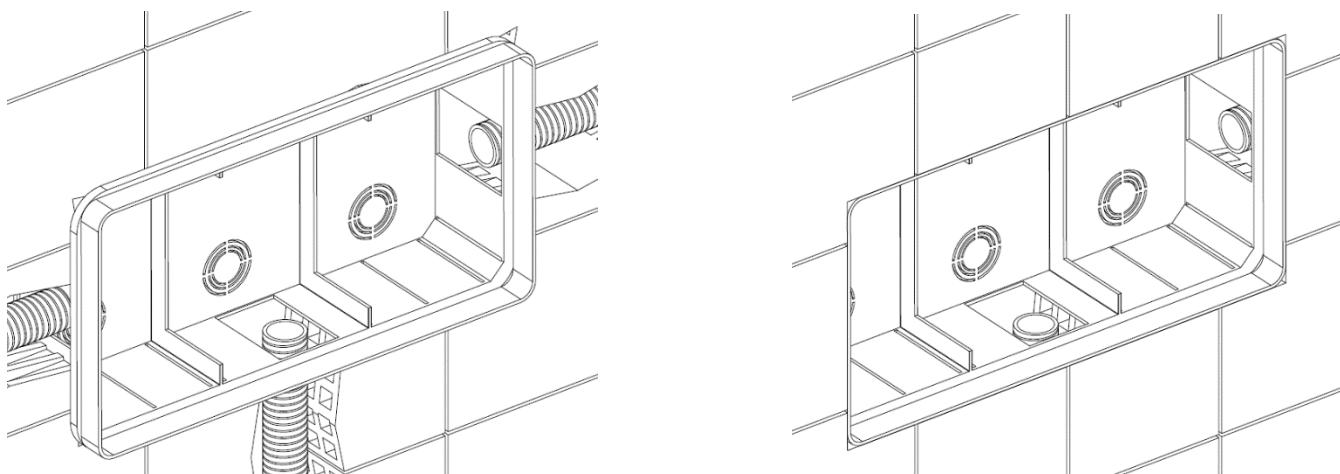
Posizionare la cassetta di derivazione da incasso nello scasso, rifinire l'intonaco e applicare il rivestimento.
