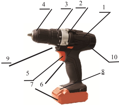
1-корпус; 2-переключатель режима скорости; 3- регулятор крутящего момента; 4- быстро зажимной патрон; 5-переключатель реверса; 6-выключатель; 7- аккумулятор; 8-фиксатор аккумулятора; 9-лампа подсветки; 10- вентиляционные каналы
