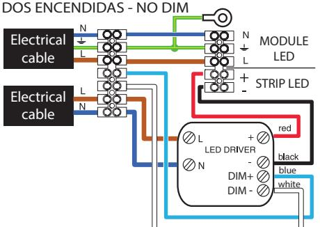
**ES** Realizar la conexión de la red eléctrica al florón según el esquema que corresponda.
