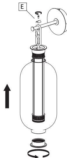
**ES** Desenroscar la pieza de fijación (D) del cuerpo principal de la luminaria, posicionar el difusor de cristal y fijarlo rosando nuevamente la pieza. Retirar el tornillo de seguridad y el protector (E).
