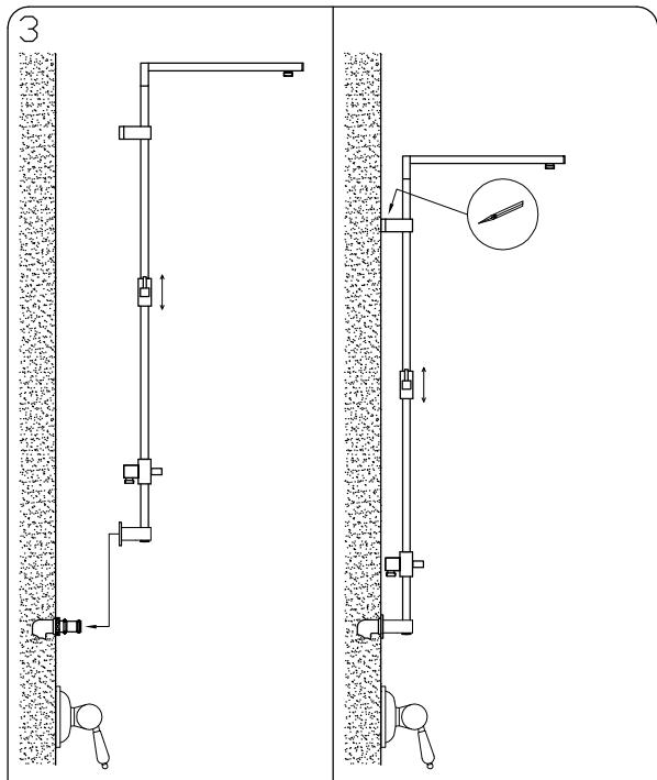
3) Inserire la colonna sul raccordo e segnare con una matita la posizione del supporto.
