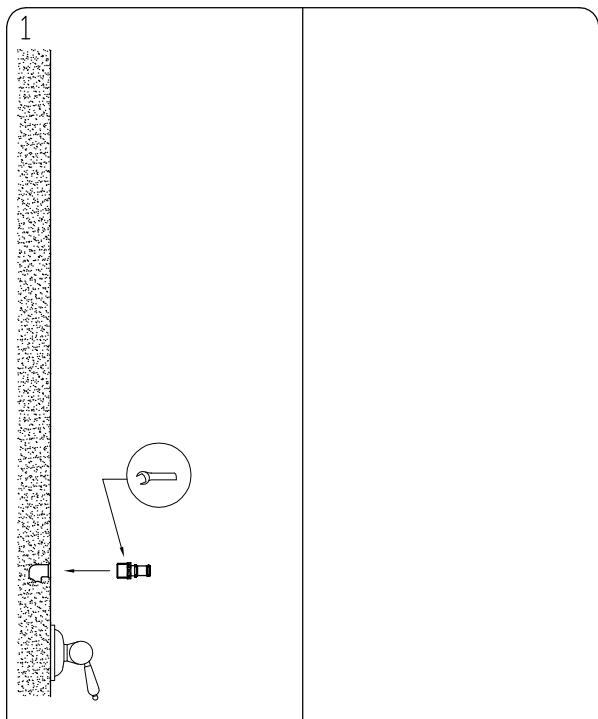
1) Installare il raccordo sull'uscita 1/2" F.
