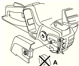
Смонтируйте шину пилы на специально предназначенном болте. Установите шину пилы в самое заднее положение. Оденьте цепь на ведущую шестерню и вставьте ее хвостовики в паз шины пилы. Эту операцию следует начать с верхней стороны шины пилы.
