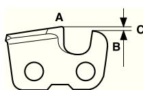
**ПРЕДУПРЕЖДЕНИЕ!** Чрезмерно большое ограничение глубины врезания увеличивает риск отдачи пильной цепи!
