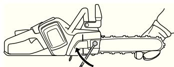
При установке новой цепи следует часто проверять ее натяжение, пока цепь не приработается. Регулярно проверяйте натяжение цепи. Регулярно проверяйте натяжение цепи. Правильно натянутая цепь обеспечивает высокое качество пиления и дольше служит.
