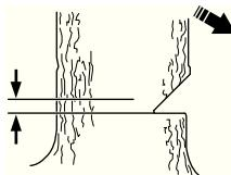
Вставьте зубчатый упор (если установлен) сзади надреза. Работайте на полном газу и вводите пильное полотно в ствол дерева постепенно, плавным движением. Следите за тем, чтобы дерево не начало перемещаться в направлении, противоположном предполагаемому направлению падения. Как только пропил станет достаточно глубоким, загоните в него клин или вагу.
