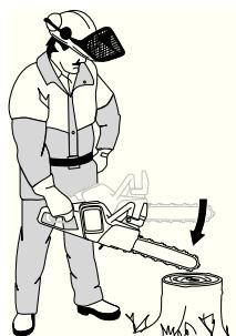
При прикосновении пильного полотна к пну должен сработать тормоз.
