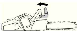
Отверните гайку крепления шины пилы и снимите крышку ведущей звездочки. Снимите транспортировочное ограждение (A).
