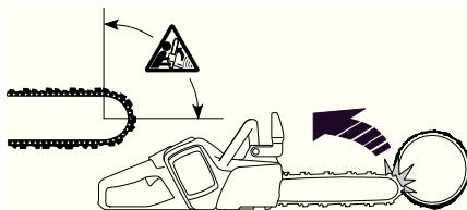
Отдача всегда происходит в плоскости резания пилы. Обычно при отдаче моторную пилу отбрасывает назад и вверх в направлении рабочего. Тем не менее моторная пила в момент отдачи может двигаться в различных направлениях в зависимости от метода резки.
