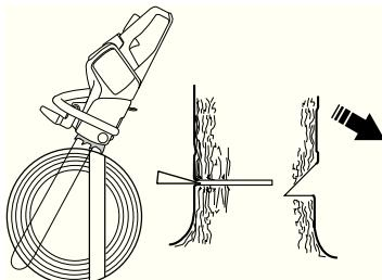
Закончить основной пропил нужно параллельно линии направляющего пропила так, чтобы расстояние между ними составляло около 1/10 диаметра ствола. Нераспиленный участок ствола называется полоса разлома (недопил).
