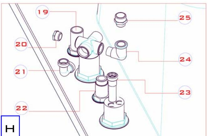
**I** - Appicare come in fig.G (con teflon canapa ecc.) il gomito 24 con la riduzione 25 su un ingresso del deviatore , il tappo 20 sull'altro ingresso e il gomito 21 sull'uscita vasca. Collegare con un flessibile 3/4Fx3/4F bocca 22 e gomito 21. Collegare con l'altro fless. 3/4Fx3/4F il gambo 23 e il raccordo 25.
