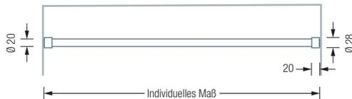
**DSGN12** Gebogene Duschvorhangstange Ø12 mm für optimale Raumnutzung und damit mehr Bewegungsfreiheit beim Duschen. Im individuellen Radius für Nische. Inklusive zweier flexibler Wandlager STW zur einfachen Befestigung und eines Durchschleuderträgers DTD zur senkrechten Deckenabhängung in 40 cm Länge. Edelstahl massiv, seidig matt handgeschliffen. Länge bis 200 cm. Gewünschtes Nischenmaß bitte angeben!
