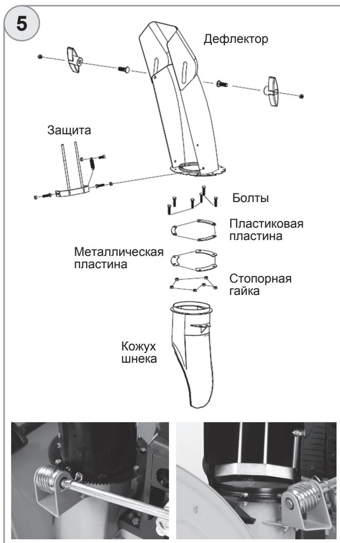
Шнек должен свободно вращаться. В противном случае проверьте правильность установки пластиковой распорной пластины. Выполните регулировку шнека с помощью винта.
