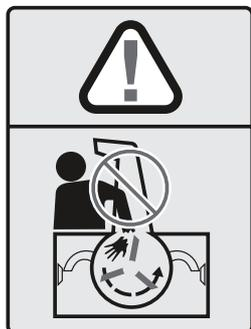
**НЕ УСТРАНЯЙТЕ ЗАСОР ЖЕЛОБА, КОГДА ДВИГАТЕЛЬ РАБОТАЕТ. ОТКЛЮЧАЙТЕ ЕГО И ВЫПОЛНИТЕ ОЧИСТКУ С ПОМОЩЬЮ ЛОПАТКИ.**
