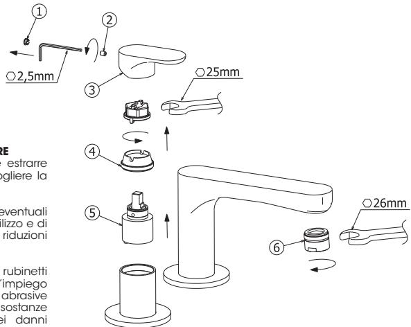
**I****INTERVENTI DI MANUTENZIONE****SOSTITUZIONE CARTUCCIA MISCELATORE E DEVIATORE**
