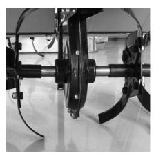
Каждый раз перед началом культивации проверяйте состояние редуктора, вала редуктора, фрез и креплений. При наличии масляных пятен на редукторе или вале обратитесь в сервисный центр. Если фрезы пришли в негодность закажите новые.
