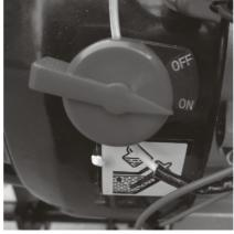
**ШАГ 2**На корпусе мотокультиватора установите зажигание в положение "ВКЛЮЧЕНО".
