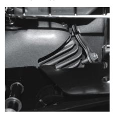
Регулярно очищайте от загрязнений (почва, остатки травы, масло) ребра цилиндра кисточкой и/или баллоном со сжатым воздухом.
