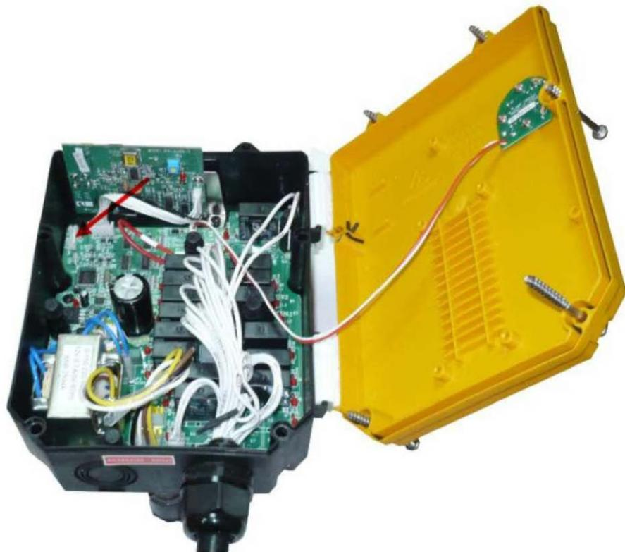
Подключение кабеля к блоку радиоуправления
