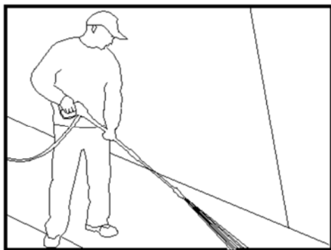
Рис. 6 - Оптимальный угол распыления воды относительно поверхности
