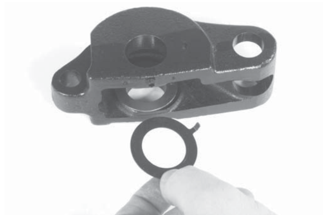
Рисунок 18 – Вставка упорной шайбы с усами
