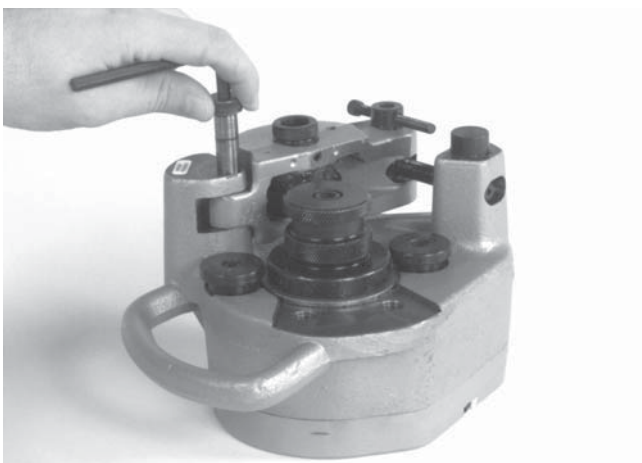
Рисунок 14 – Выкручивание винта с буртиком
