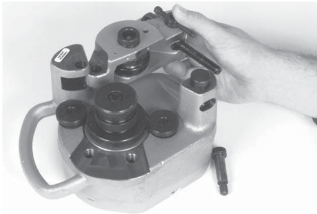
Рисунок 15 – Снятие рабочего рычага
