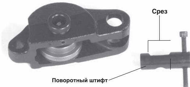
Рисунок 19 – Положение поворотного штифта
