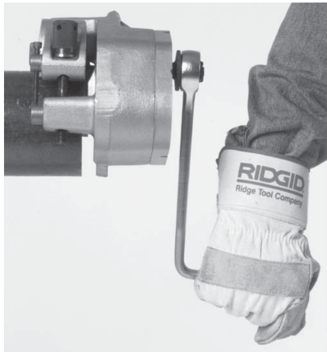
Рисунок 6 – Накатка желобков на трубу
