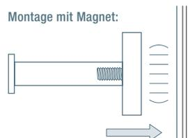
Wandhaken-Variante H12-54 in Kombination mit Topfmagnet (vernickelt) mit Gewindepapfen, Haftkraft ca. 38 kg – bei Bestellung bitte angeben
