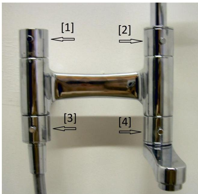
La manopola [1] regola la temperatura dell'acqua miscelata (senso orario=calda / senso anti orario=fredda). E' previsto un blocco di sicurezza alla temperatura di 38°C; se si desidera aumentare la temperatura dell'acqua miscelata occorre premere il pulsante posto sulla manopola stessa.
