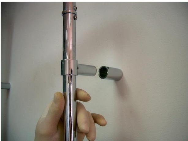
Inserire il perno nel supporto e la colonna sul raccordo di uscita superiore.
