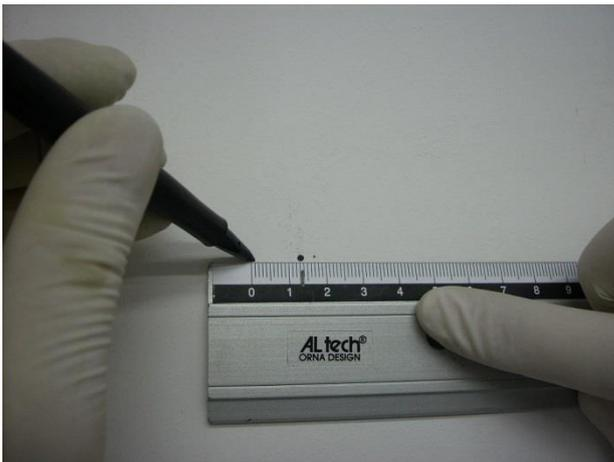
Marcare la posizione del centro del supporto di fermo spostandosi di 12.5 mm.
