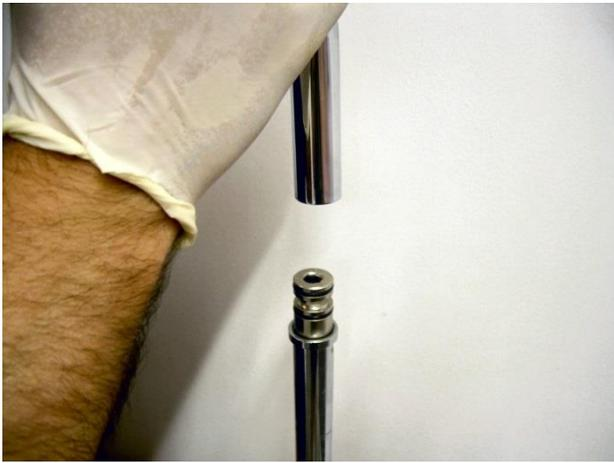
Inserire la colonna sul raccordo di uscita superiore.
