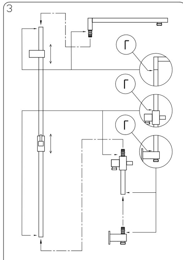
3) Inserire il braccio, il deviatore ed il blocco esterno sulla colonna e fissarli.
