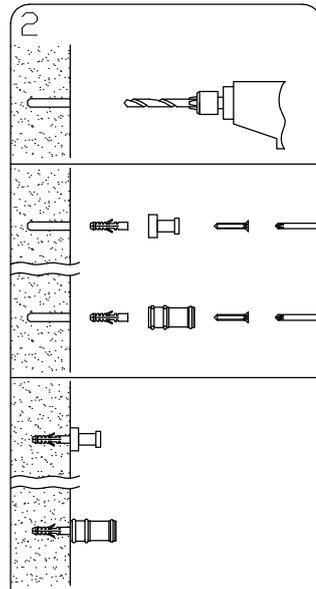
2) Forare con punta da 8mm, inserire i tasselli e fissare i supporti con le viti.
