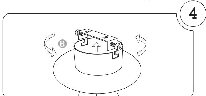
Encajar el florón en la pieza de sujeción y apretar los tornillos de seguridad.
