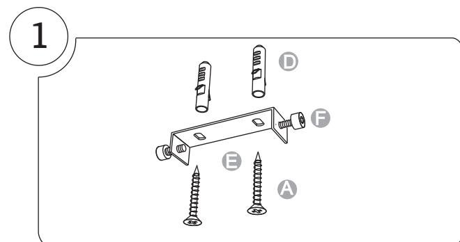
Realizar los agujeros en el techo, colocar los tacos y atornillar la pieza de sujeción.
