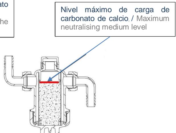
Nivel máximo de carga de carbonato de calcio / Maximum neutralising medium level
