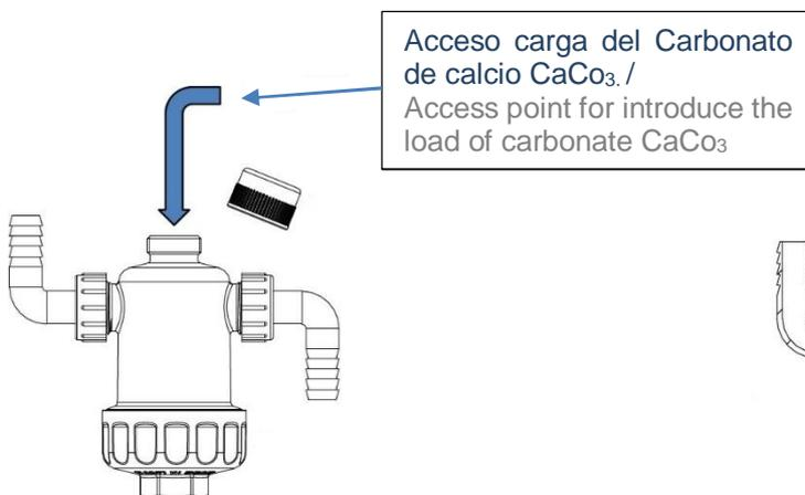
Acceso carga del Carbonato de calcio  $\text{CaCO}_3$  / Access point for introduce the load of carbonate  $\text{CaCO}_3$
