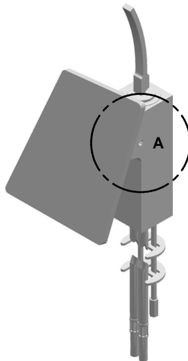
Inserire la chiave a brugola nel foro della regolazione **DETTAGLIO A** ed ottimizzare il getto dell'acqua.
