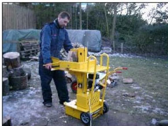
Данный дровокол раскалывает поленья длиной 10-105 см. Рабочая высота регулируется путем нажатия на обе рукоятки (вертикально) до нужной высоты. На рис. можно видеть, каким образом регулируется высота с помощью одной из рукояток. Ослабьте гайку, вытяните железный прут, служащий показателем высоты, затем снова затяните гайку.
