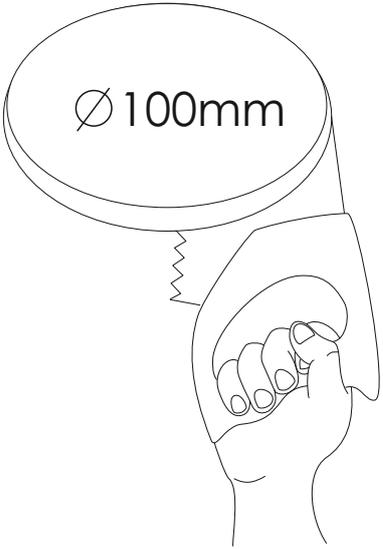
1. Подготовьте монтажное отверстие для установки светильника
