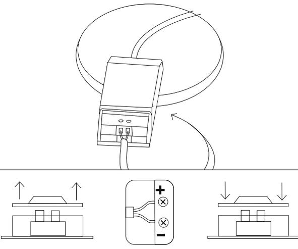
2. Подключите провода питания к драйверу. Подключите светильник к драйверу, строго соблюдая полярность (+-)
