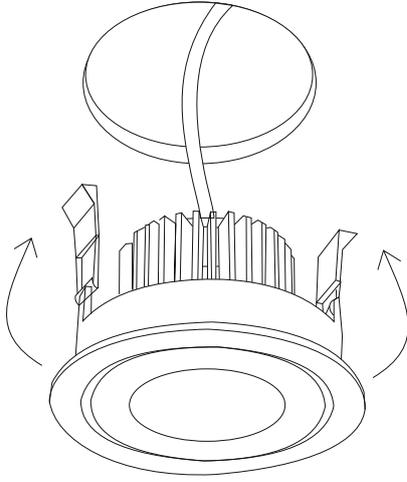
3. Отогните пружинные ушки светильника вверх и установите светильник в монтажное отверстие.
